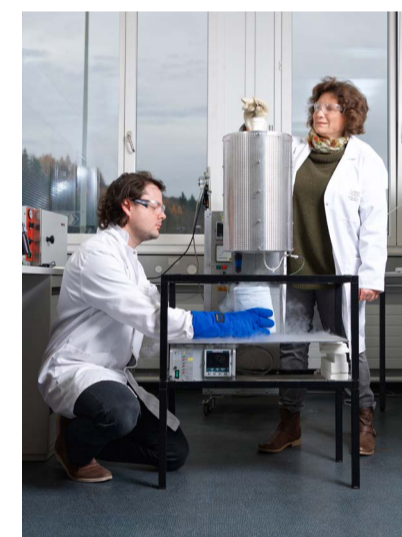
Mickaël Morin et Marisa Medarde, chercheurs au PSI, congèlent l'arrangement atomique du matériau multiferroïque YBaCuFeO5. L'échantillon de matériau est d'abord chauffé dans un four à 1000 degrés Celsius, avant d'être plongé dans un récipient rempli d'azote liquide à moins 200 degrés Celsius. Photo © Institut Paul Scherrer/Markus Fischer
