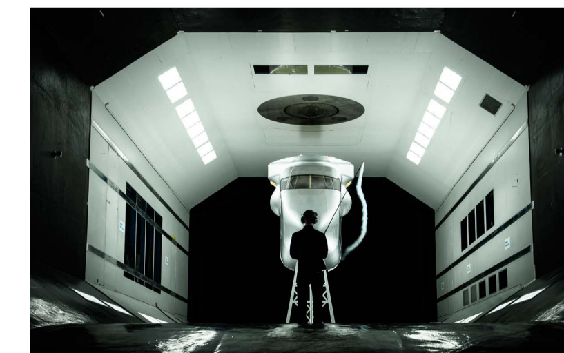
Test en soufflerie du poste de pilotage du Solar Impulse 2
