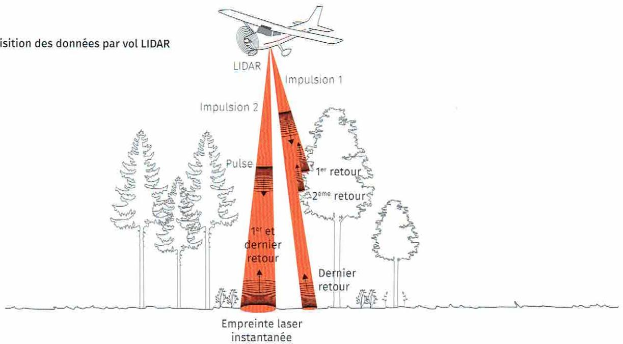
Construction des différents modèles numériques sur base du nuage de points obtenu par le LIDAR
