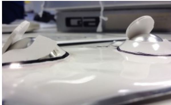
Test de résistance mécanique de la peinture suite à la déformation lente de son support. Cliquer pour agrandir
