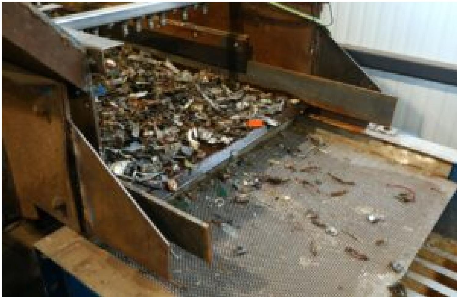
La technologie MATVISION est capable de traiter en une seule passe jusqu'à 20 types de métaux différents © Michel Houet / ULiège
