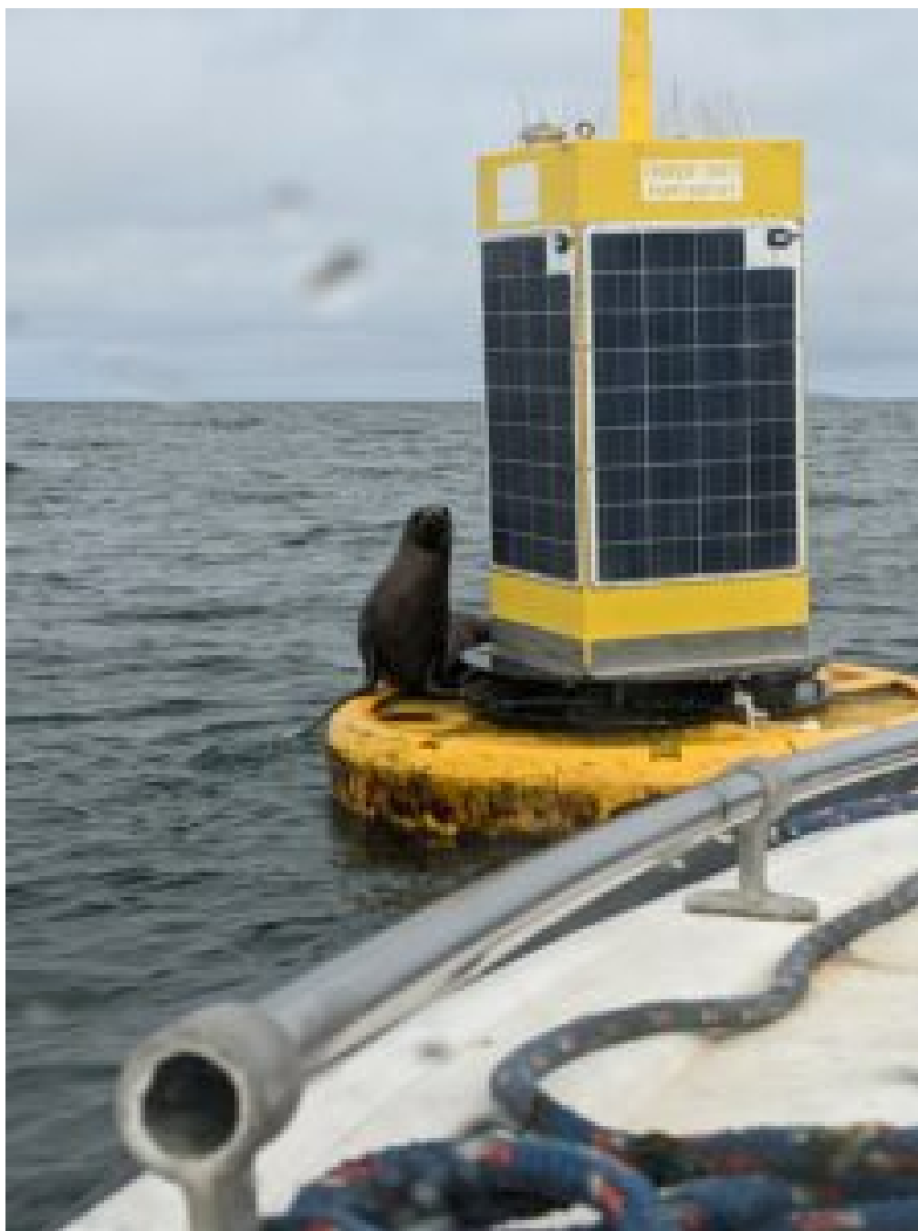
Bouée océanographique dont la maintenance est confiée au centre de recherche i-mar avec lequel Cécile Pujol. « Cette bouée sert à mesurer la température de l'eau, la salinité, la concentration en
