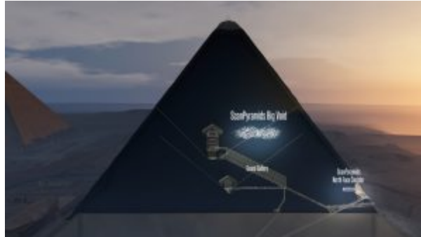
Localisation de la nouvelle cavité détectée par muographie. © ScanPyramids. (Cliquer pour agrandir)
