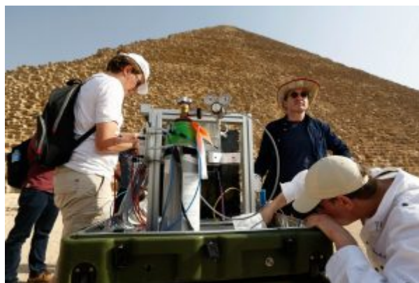
Mise en place d'un détecteur de muons sur la face nord de la grande Pyramide. © ScanPyramids (Cliquer pour agrandir)
