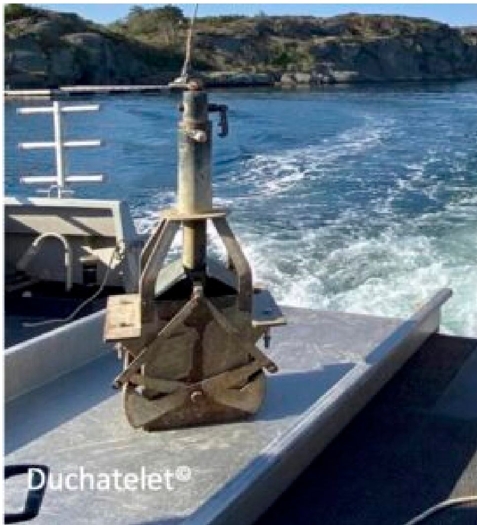
Pour récolter les Ophiures, une benne dotée de grandes mâchoires est téléguidée depuis le pont d'un bateau © Duchatelet
