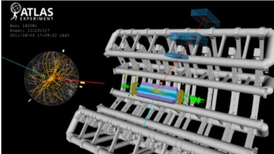
Événement candidat pour un boson W se désintégrant en un muon et un neutrino à partir de collisions proton-proton enregistrées par ATLAS avec des faisceaux stables du LHC à une énergie de collision de 7 TeV. © CERN
