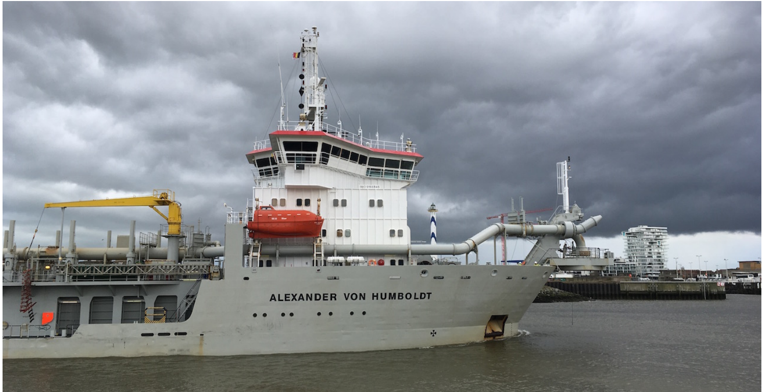
Le navire de dragage Alexander von Humboldt, qui prélève du sable au large, rentre au port. © DailyScience
