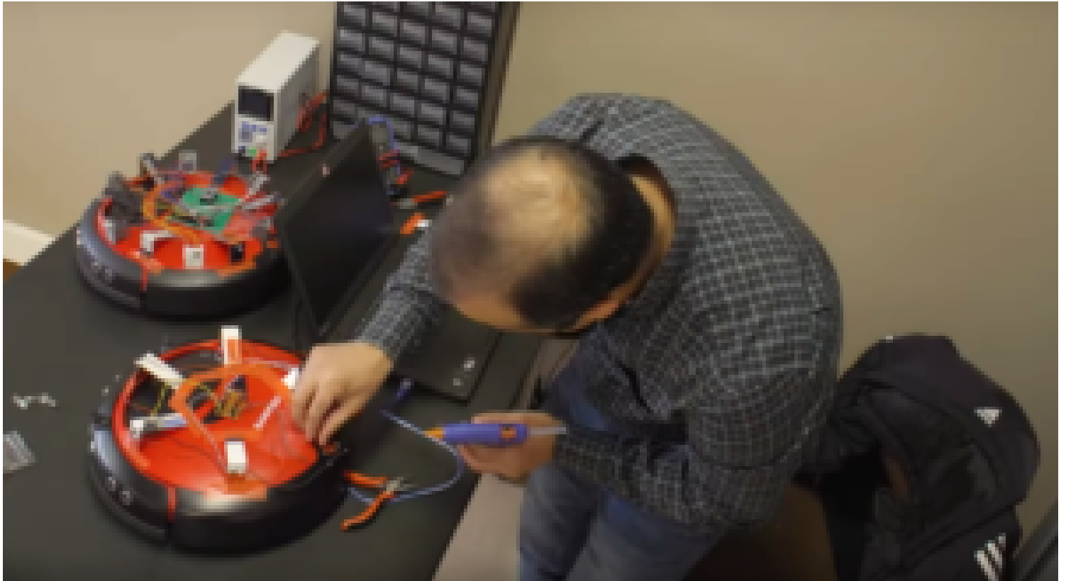
Montage des différentes pièces du socle du robot © UNamur
