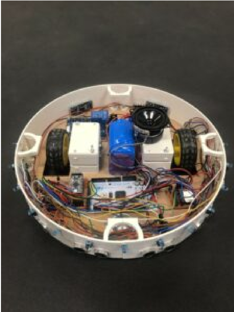
Socle d'un robot contenant les batteries, capteurs et autres pièces électroniques et mécaniques © Elio Tuci / UNamur
