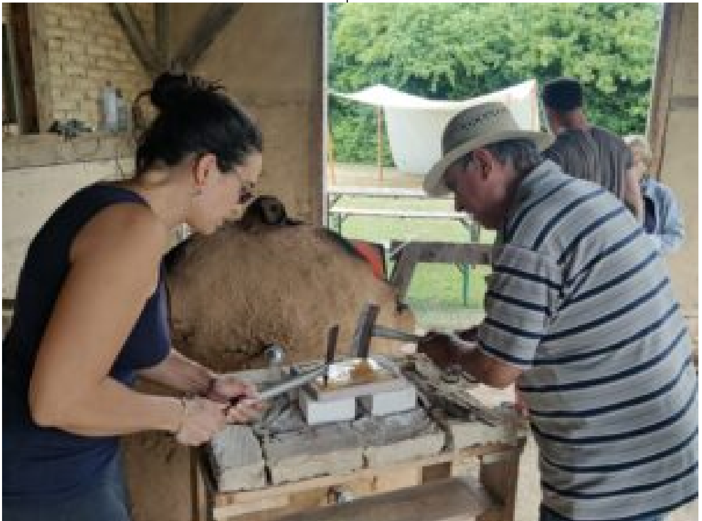
Verre fondu sorti du four de fusion pour être travaillé © Géraldine Frère
