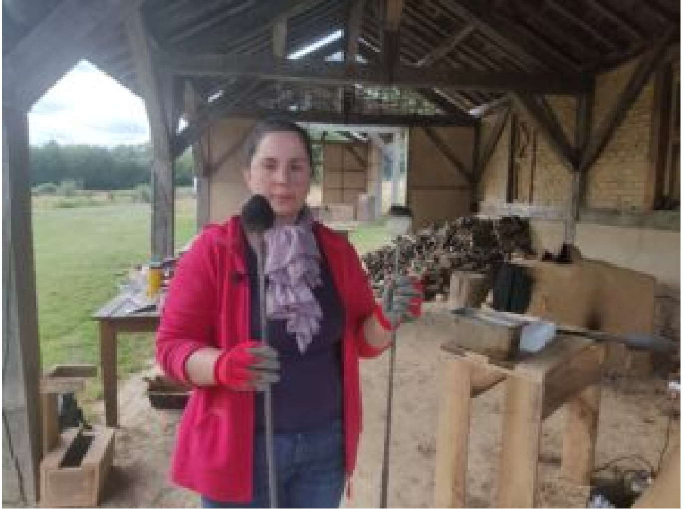
Géraldine Frère tenant des ferrets munis d'une patate (boulette d'argile) au bout pour cueillir le verre © Géraldine Frère
