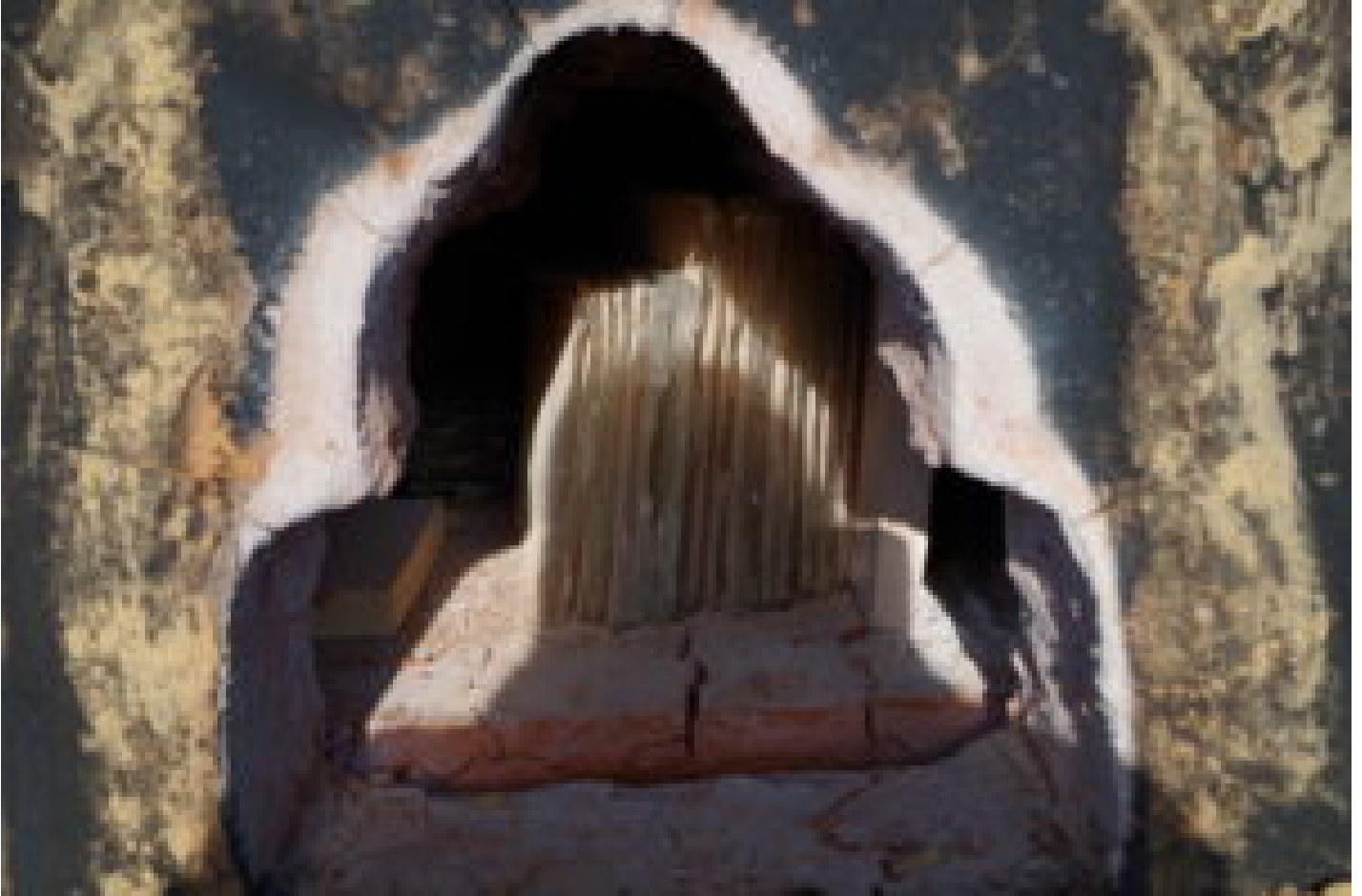
Vitres à faire refroidir déposées dans le four de recuisson © Géraldine Frère
