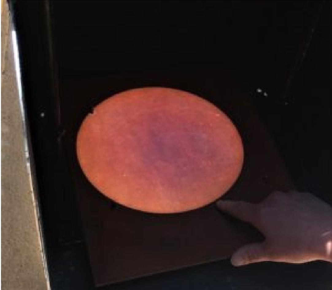
Table à dessin des astronomes qui surveillent le Soleil. Elle placée sous le télescope solaire. C'est sur cette table qu'une feuille de papier est fixée et que l'astronome dessine les taches solaires qu'il observe
