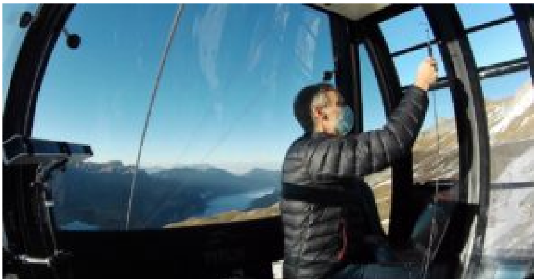
Mesure des flux d'air dans une cabine de téléphérique à l'aide de capteurs de pression d'air © Streamwise GmbH
