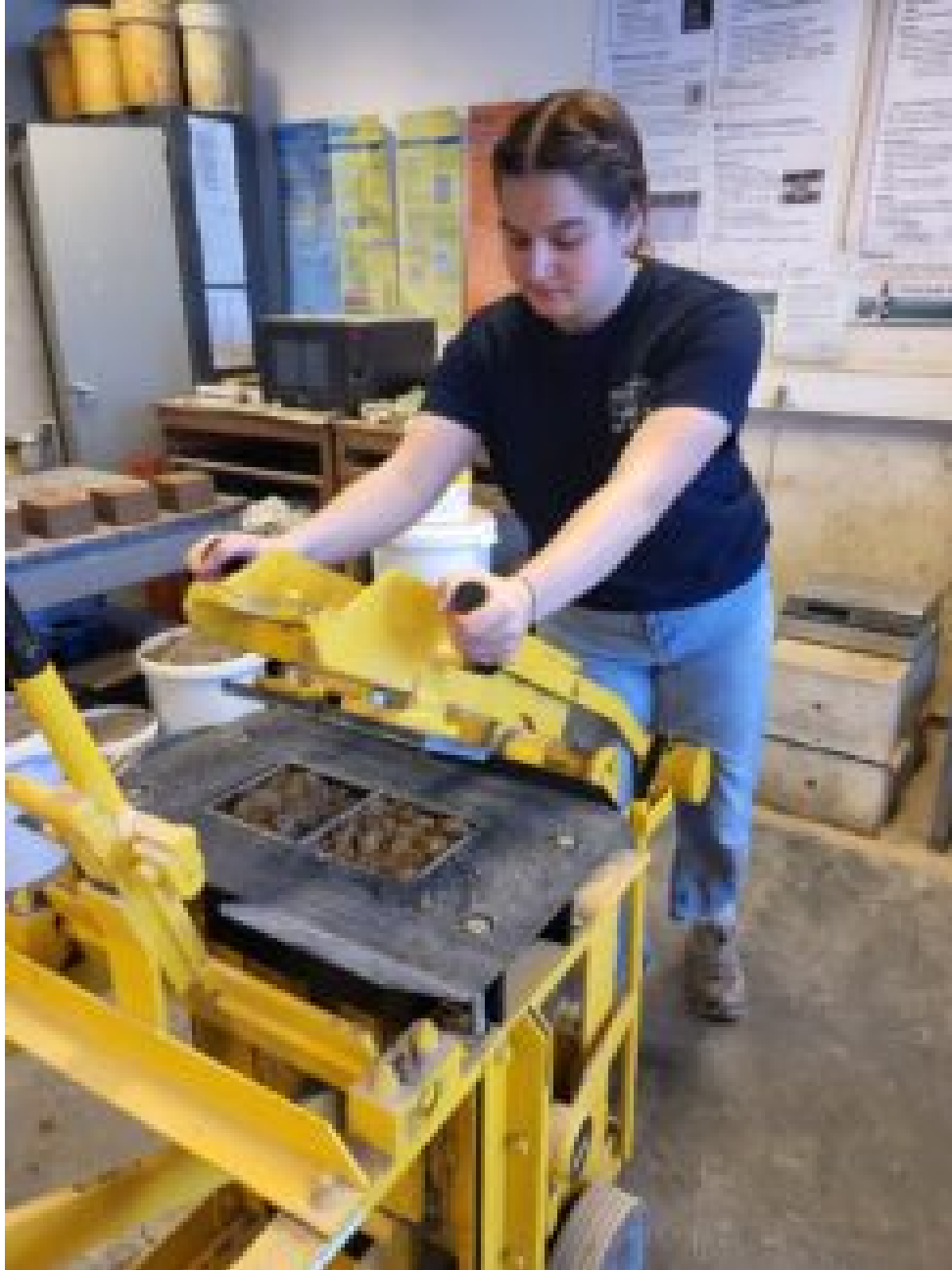
Production de briques en terre crue à l'aide d'une presse manuelle mécanique Testaram © Elisa Hofmann
