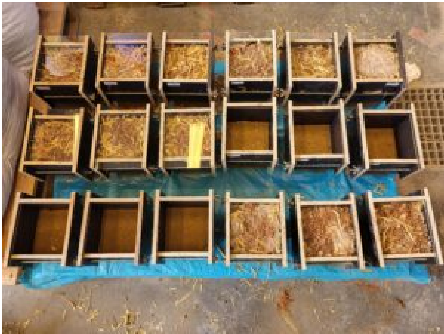
Moules en bois bakélisés fabriqués pour la production de matériaux biocomposites à base de mycélium © Elisa Hofmann
