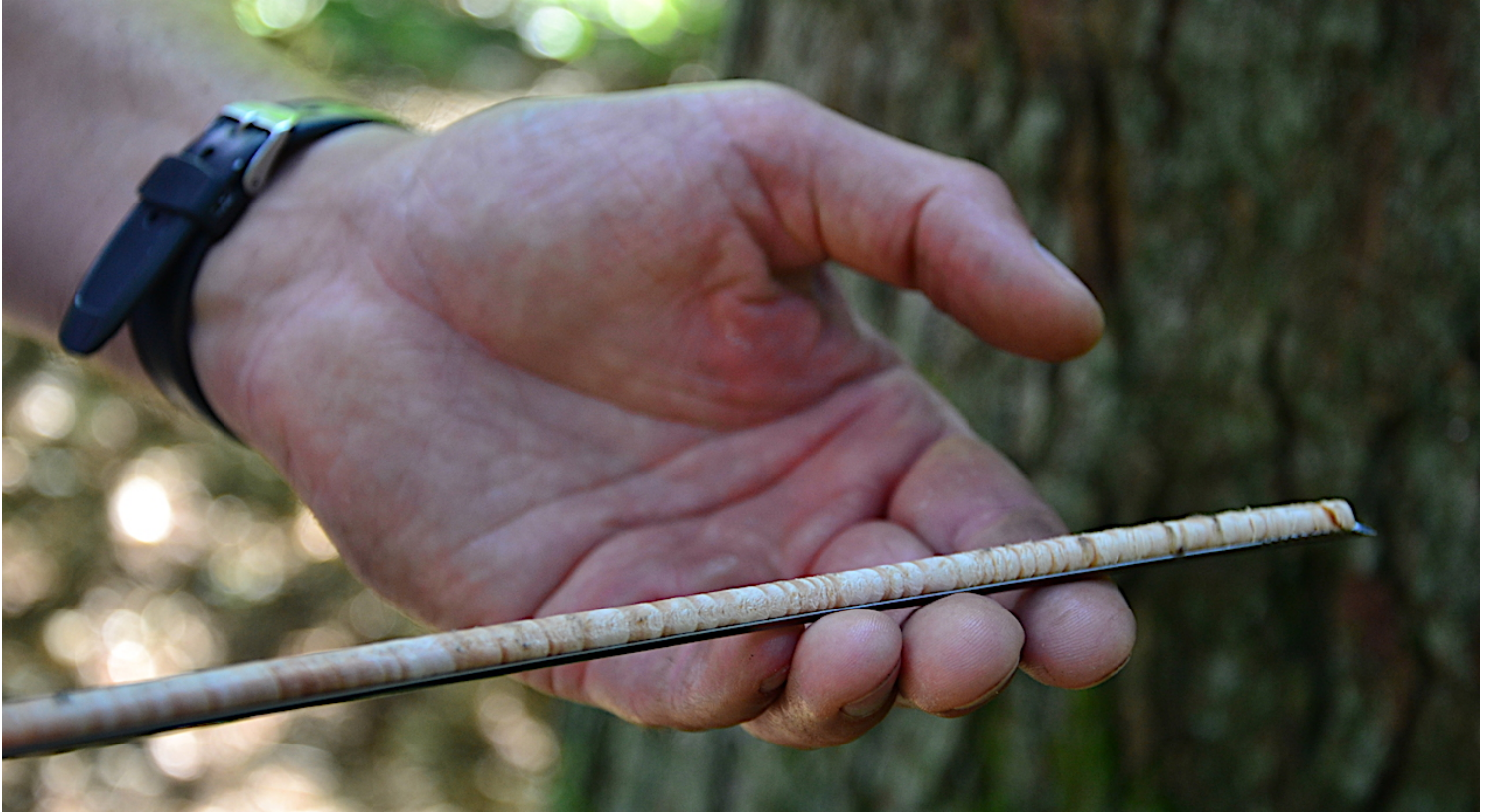
Détail de la carotte prélevée à la tarière. © UCLouvain-ELIE
