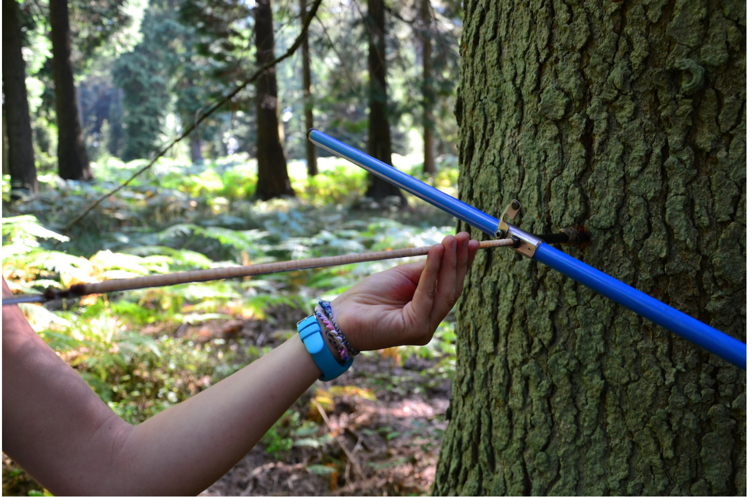
Prélèvement d'une carotte de sapin de Nordmann à la tarière à main dans la forêt de Saint-Hubert. © UCLouvain-ELIE
