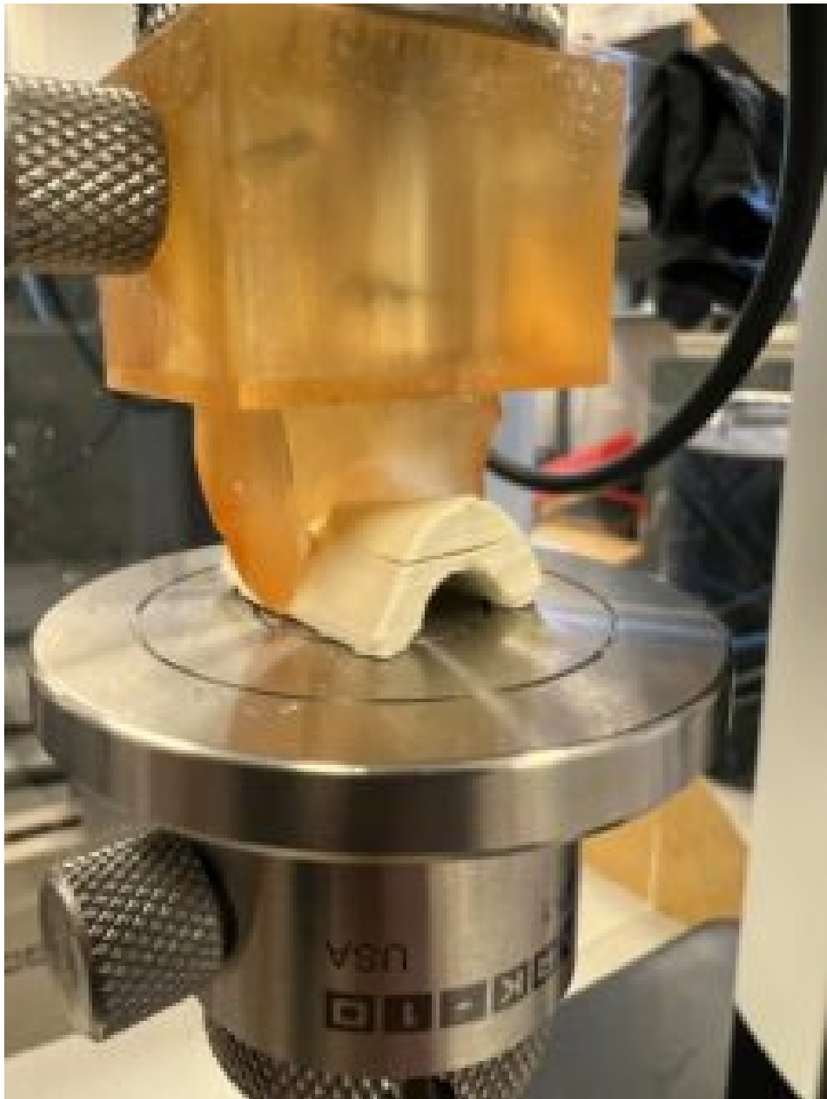
Test robotisé de broyage d'un morceau d'os synthétique par une dent de Smilodon fatalis © Melvin Vankelst / ULiège / IRSNB
