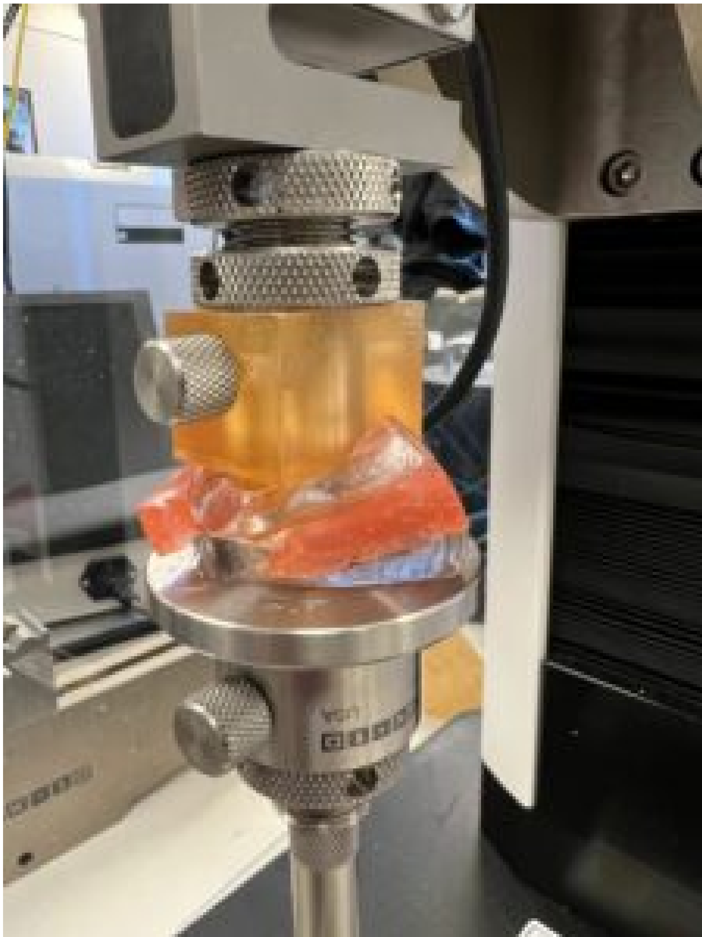
Test robotisé de découpe d'un morceau de gel balistique mimant la peau, la graisse et le muscle par une dent de Smilodon fatalis (grand félin préhistorique) © Melvin Vankelst /
