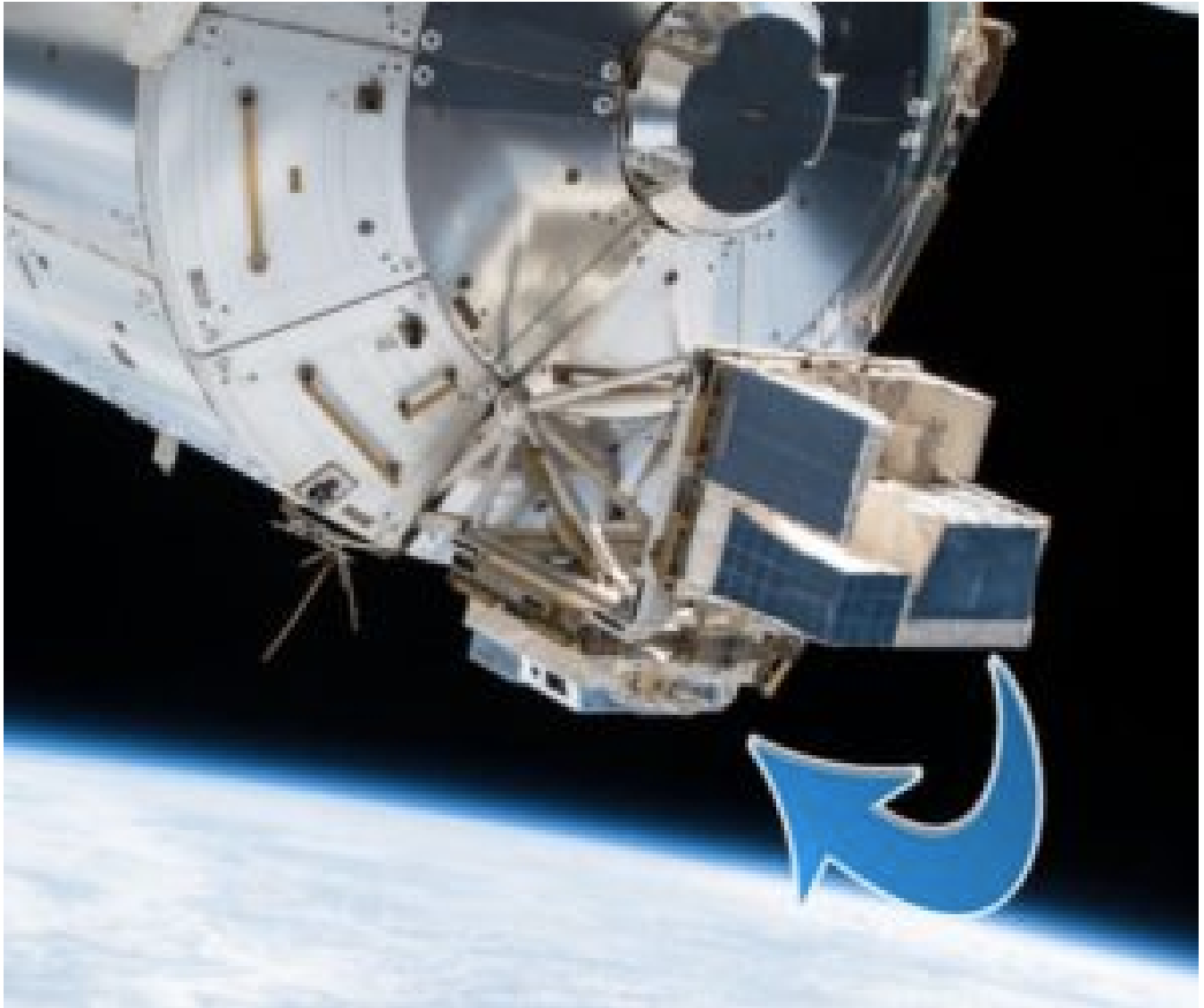
Rotation de 90° de ASIM, l'instrument européen chasseur d'orages © ASIM / ESA
