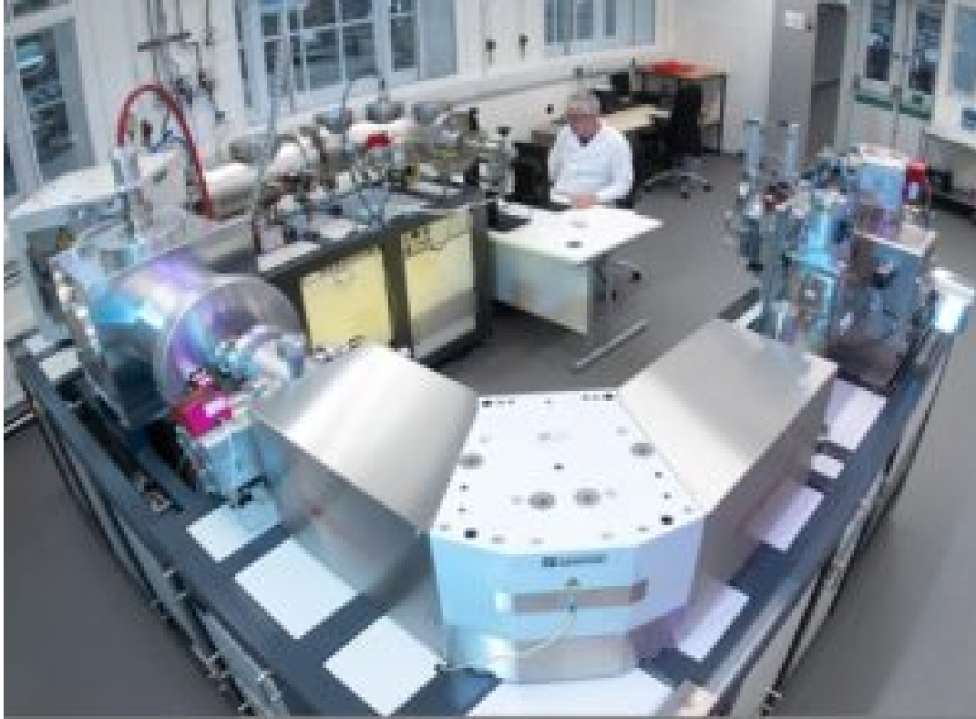
La spectrométrie de masse à accélérateur est une forme de spectrométrie de masse qui accélère les ions à des énergies cinétiques extraordinairement élevées avant l'analyse de masse © Oxford University
