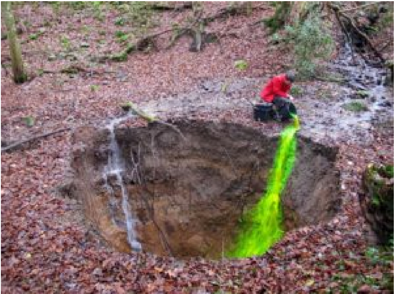
Versement du colorant fluorescent dans un puits © TRAQUA / UNamur
