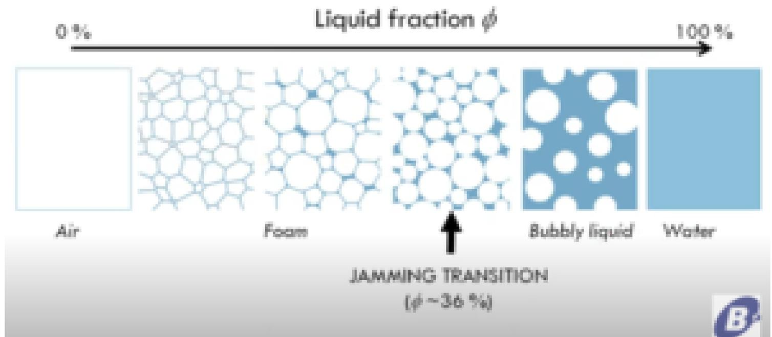
Evolution de la forme des bulles en fonction de la teneur en eau et en air, et représentation du point de "Jamming Transition" ©B.USOC - Cliquez pour agrandir
