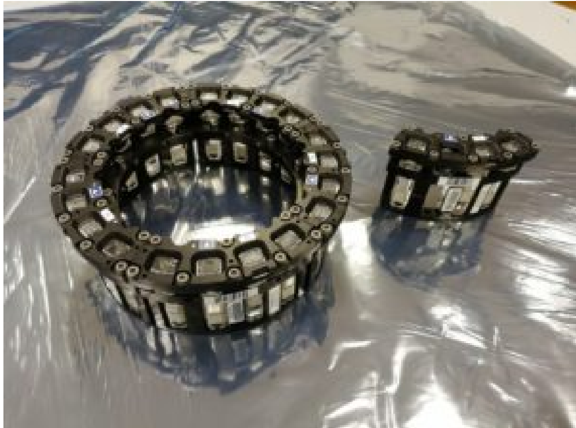
Carrousel avec 20 alvéoles de l'expérience FOAM-C © B.USOC - Cliquez pour agrandir
