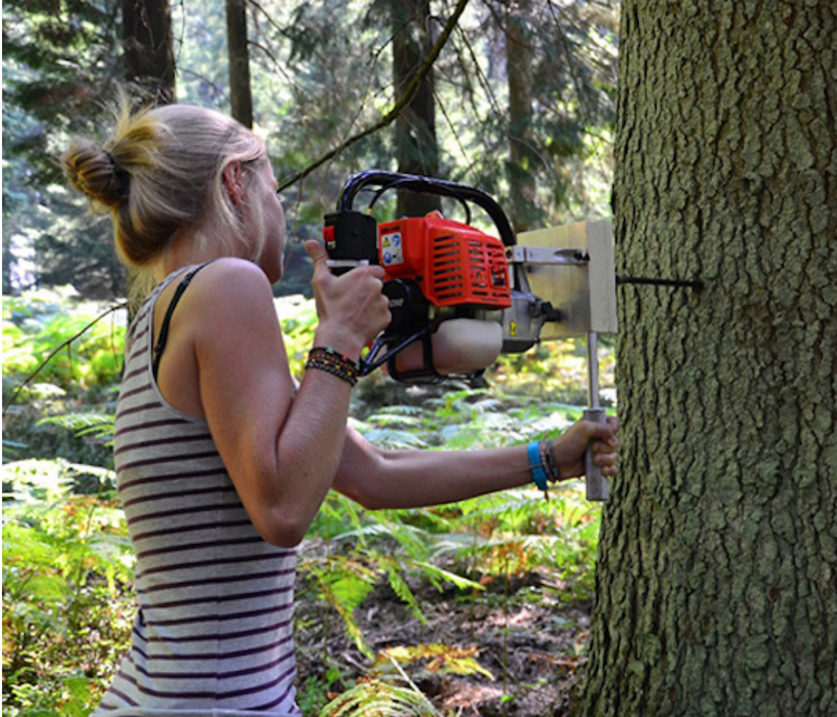
Carottage d'un Nordmann dans la forêt de Saint-Hubert © UCLouvain-ELIE
