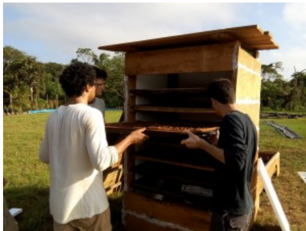
Les grilles sont superposées dans le séchoir
