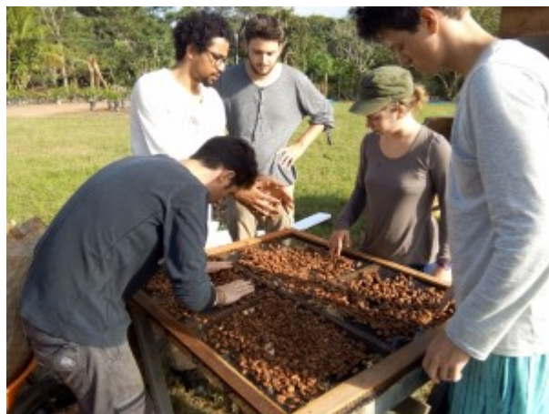
Les fèves de cacao sont disposées en mono-couche sur une des grilles du séchoir
