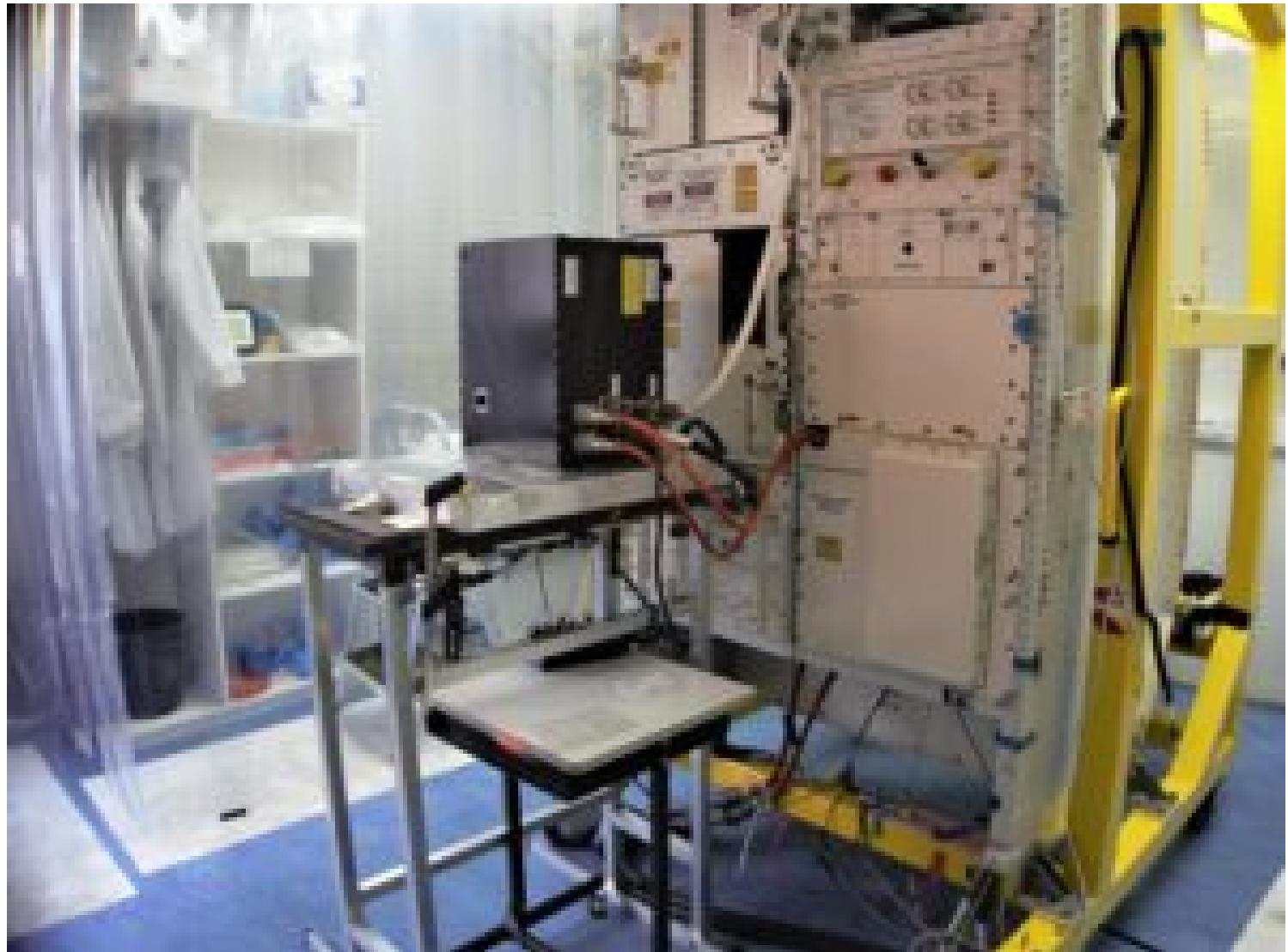
Cette grosse structure de 800 kilos, c'est l'équivalent en taille réelle du FSL actuellement en orbite à bord de l'ISS. La boîte noire de 35 kilos, c'est la version terrestre du conteneur expérimental Rubi. © Laetitia Theunis
