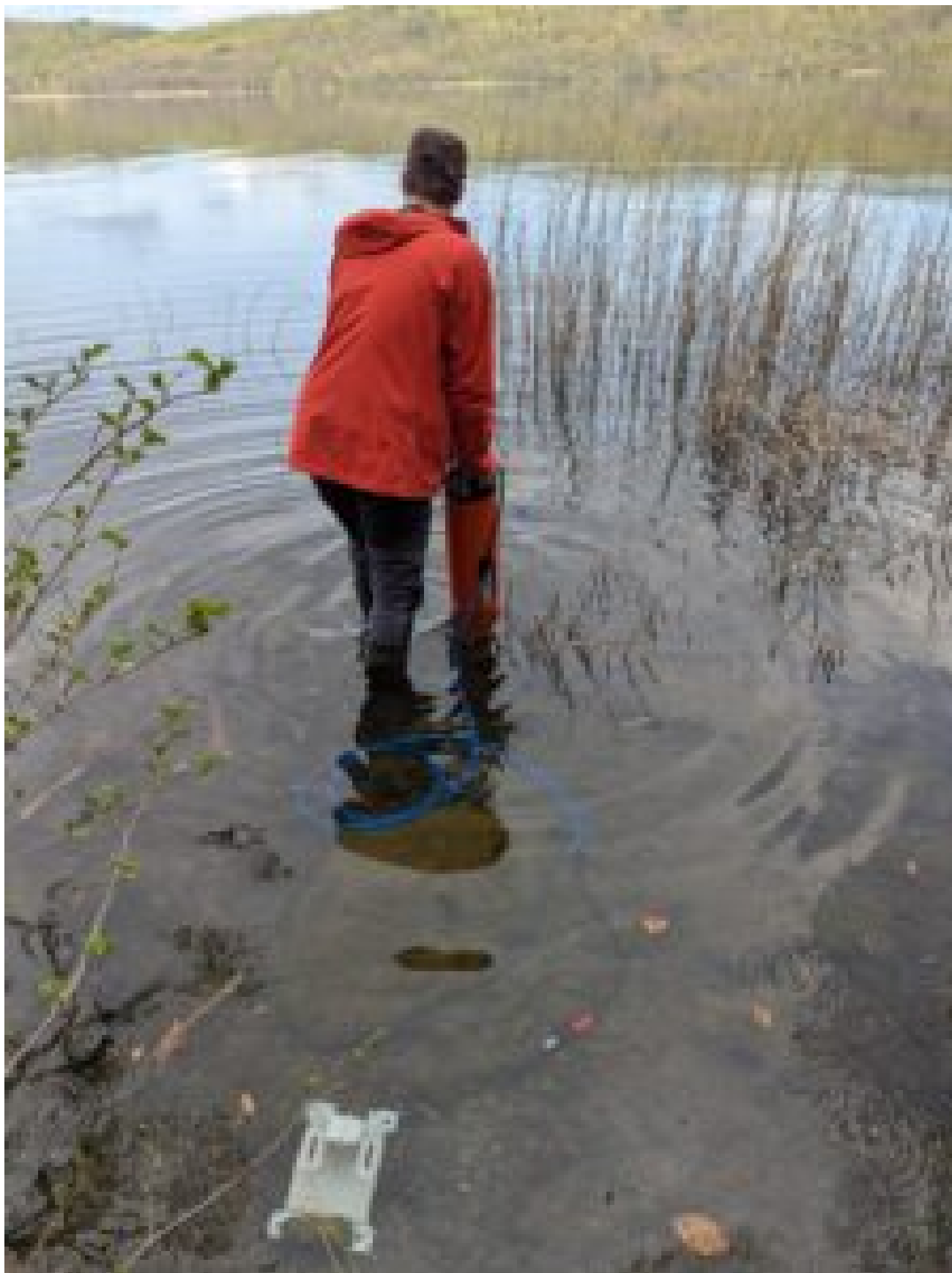
Hydrophone (bouteille orange) que l'on s'apprête à plonger dans le lac Laache See du volcan éponyme, dans l'Eifel (Allemagne) © Corentin Caudron
