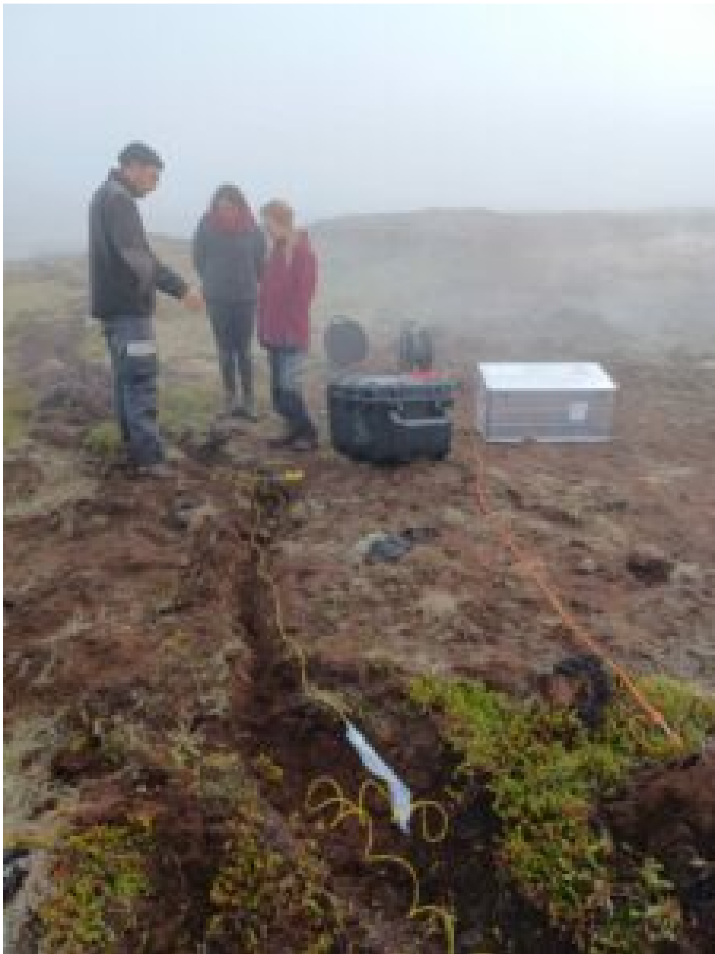
Fibre optique (en jaune) dans un sillon sur les flancs du volcan Gunnuhver (Islande) © Corentin
