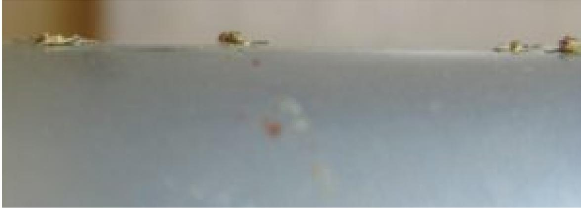
Insectes collés sur une aile d'avion, augmentant les frottements et réduisant l'aérodynamisme © CHOPIN
