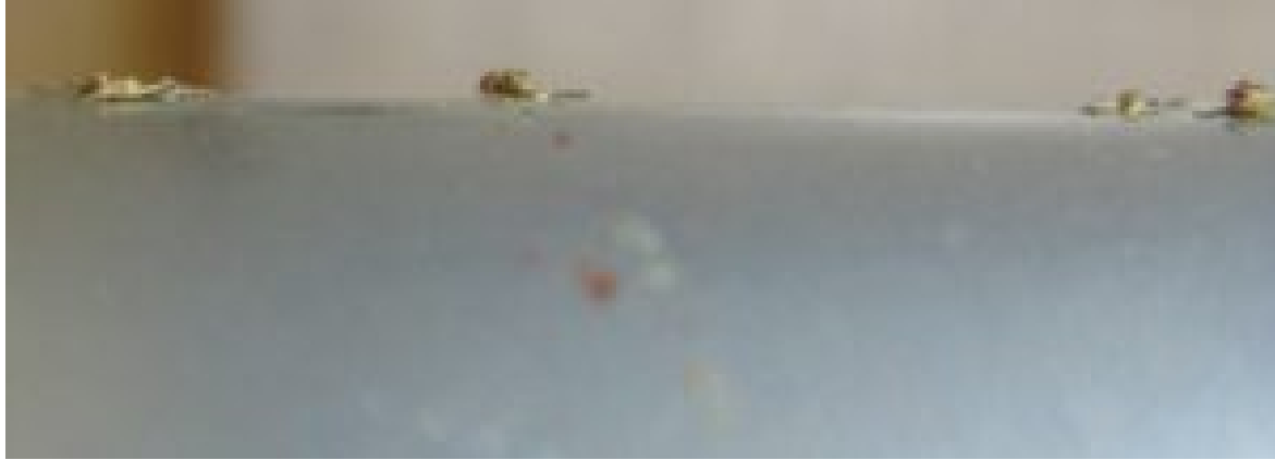
Insectes collés sur une aile d'avion, augmentant les frottements et réduisant l'aérodynamisme © CHOPIN
