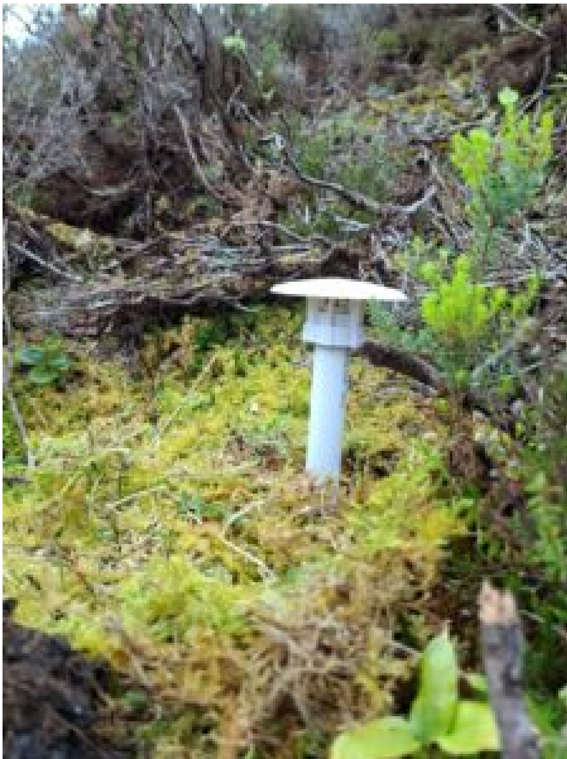
Capteur d'humidité du sol installé sur les flancs du volcan Fogo (Açores) © Alexander Yates
