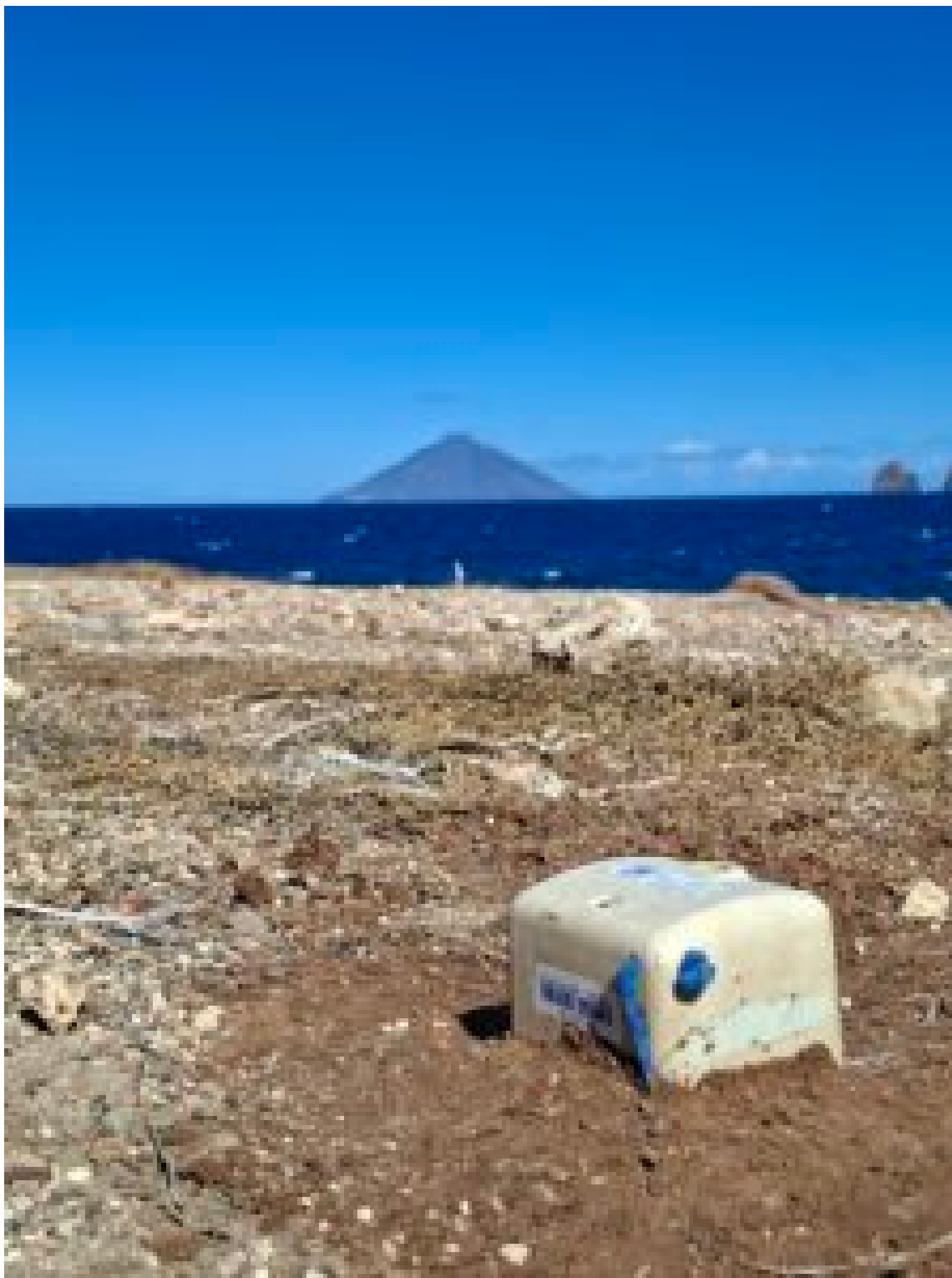
Station sismique temporaire déployée sur l'île de Panarea (Italie) en 2025, avec le volcan Stromboli à l'horizon © Alexander Yates
