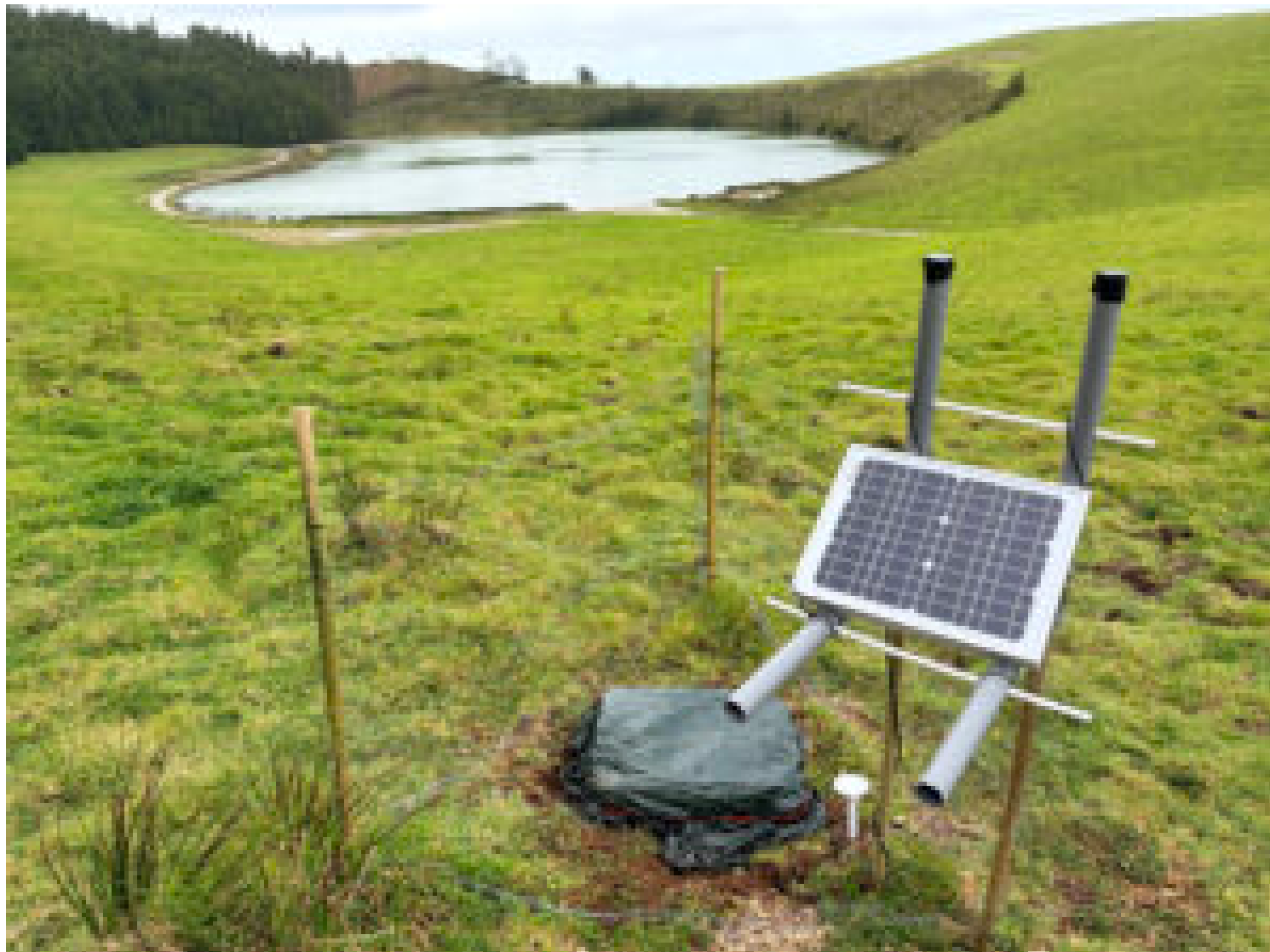
Site de mesure actuellement en activité sur le volcan Fogo (Açores), combinant enregistrements sismiques et suivi de l'humidité du sol © Frederik Link
