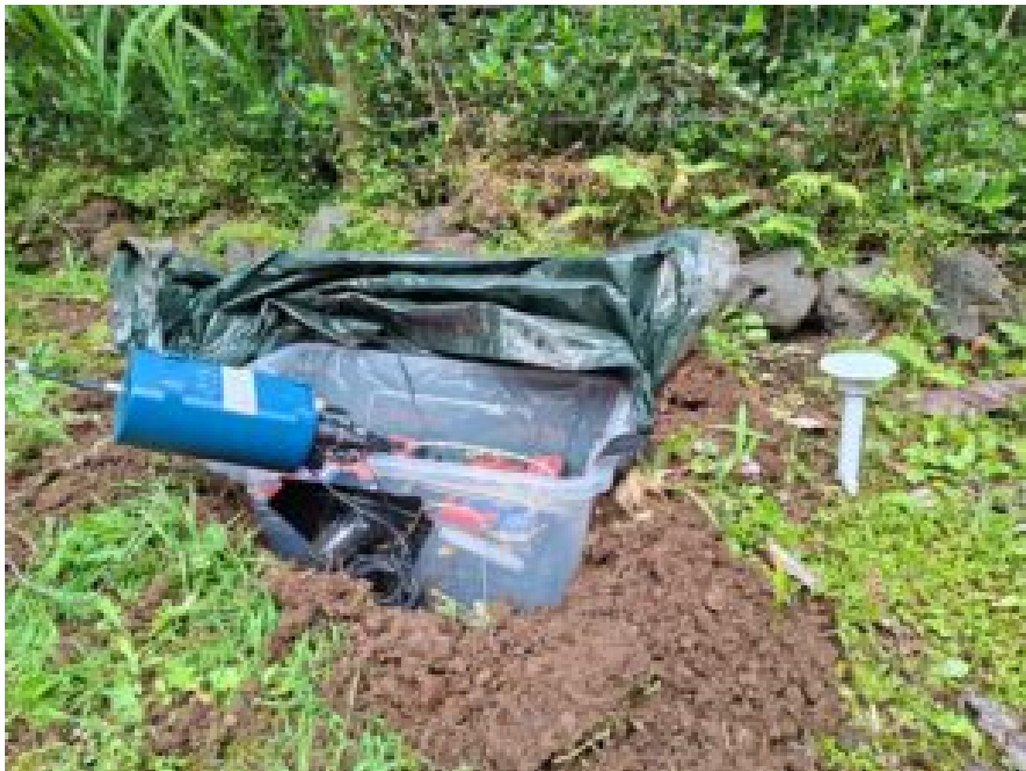
Éléments d'une station sismique temporaire et d'un capteur d'humidité du sol © Alexander Yates
