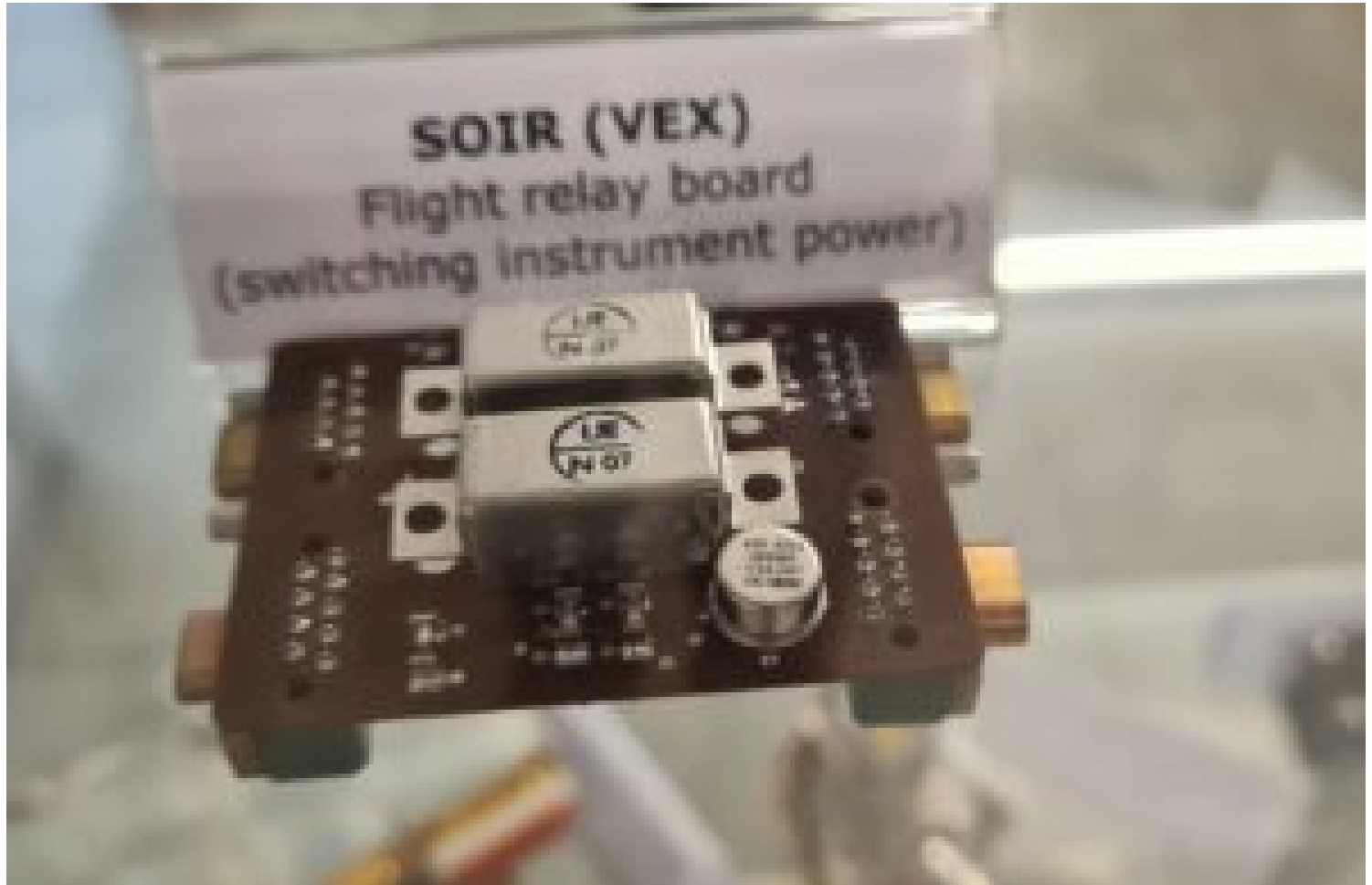
Carte relais de vol développée pour l'instrument SOIR © Camille Stassart
