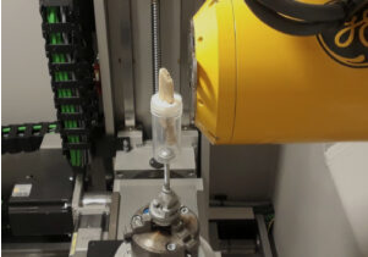
Scan d'un outil en os néandertalien en microtomographie à rayons X, au laboratoire PACEA à Bordeaux (France) © CNRS - N. Vanderesse
