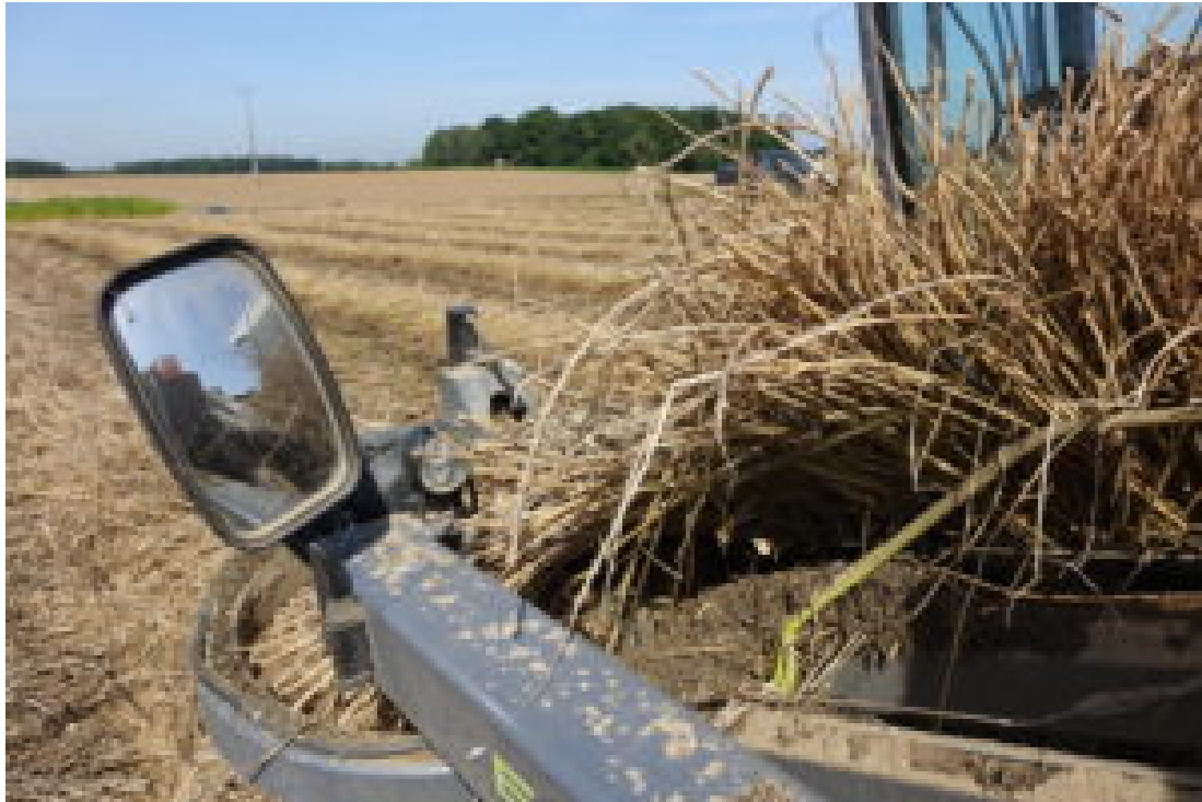
Retourneuse retournant les pailles de chanvre. Villers-le-Bouillet 2021 © Valbiom
