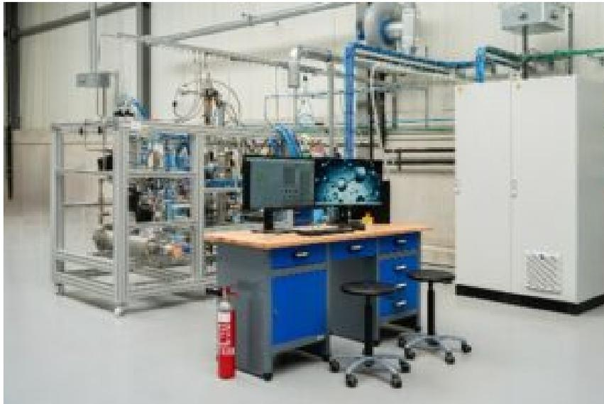
Banc d'essai représentatif capable de produire jusqu'à 250 g/h de carbone © Région wallonne / MecaTech/GreenWin
