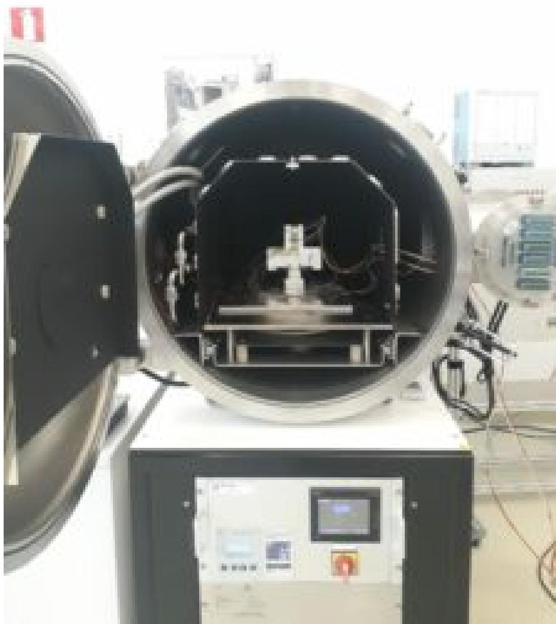
L'instrument Grass lors des tests en "thermal vacuum chamber" ©
