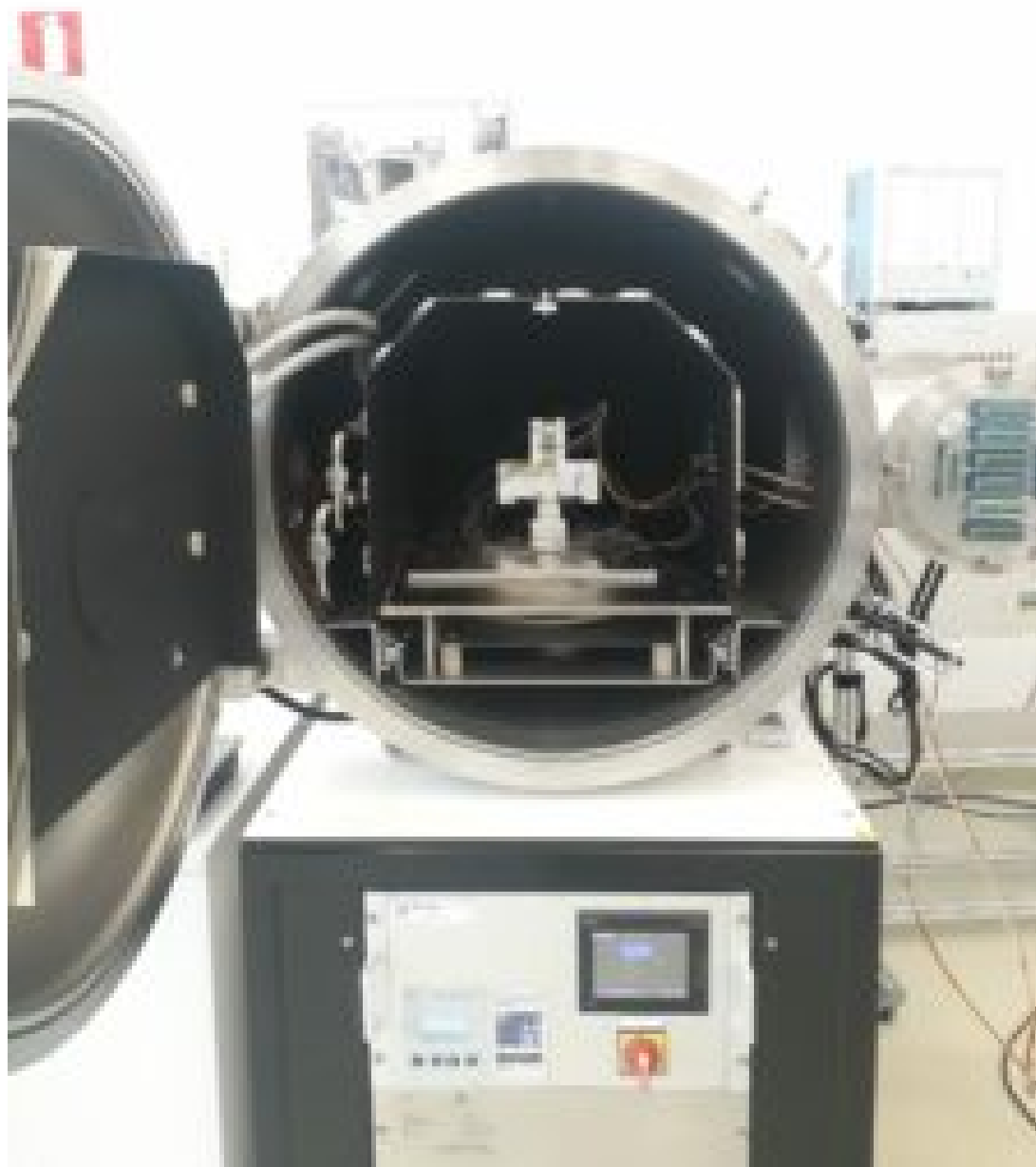
L'instrument Grass lors des tests en "thermal vacuum chamber" © Observatoire royal de Belgique
