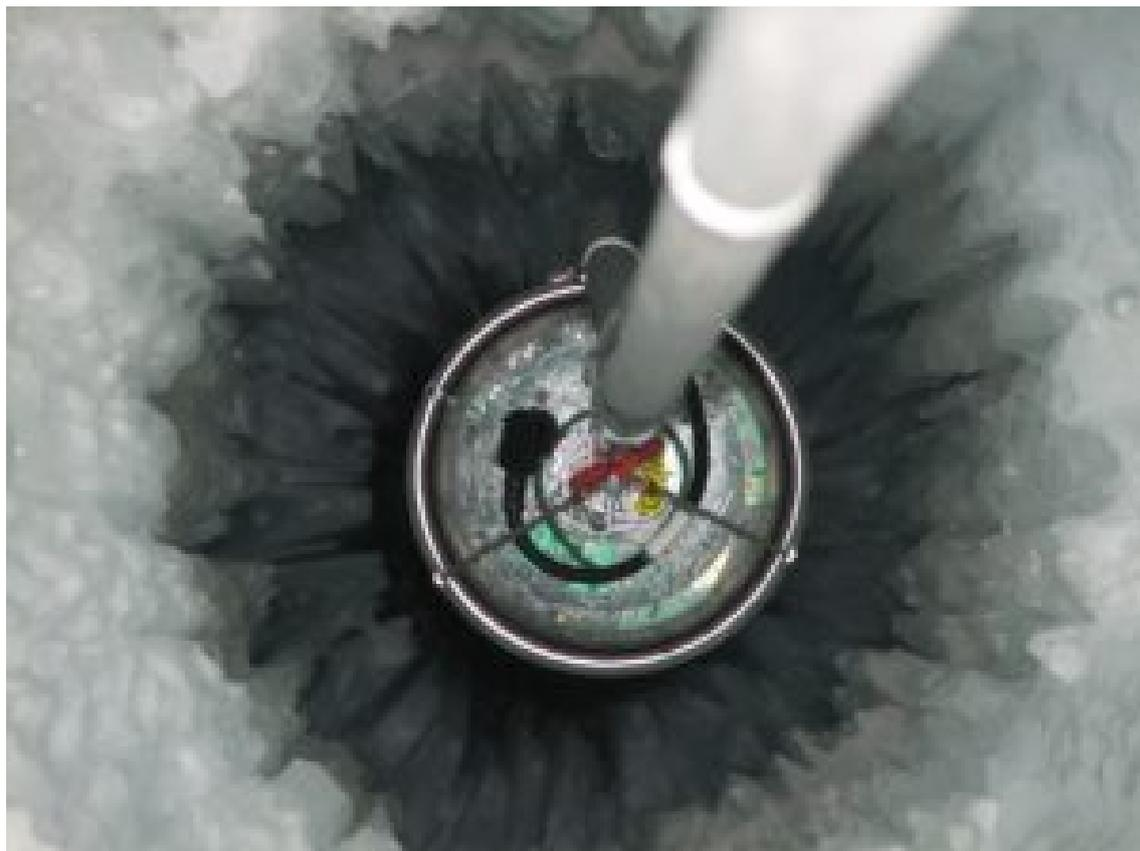
Immersion d'une chaîne de détecteurs du télescope IceCube ©
