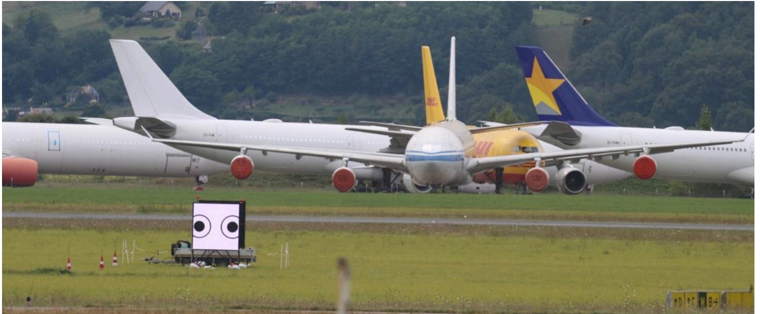
Les cercles concentriques diffusés sur les écrans digitaux éloignent durablement les rapaces. © CNRS
