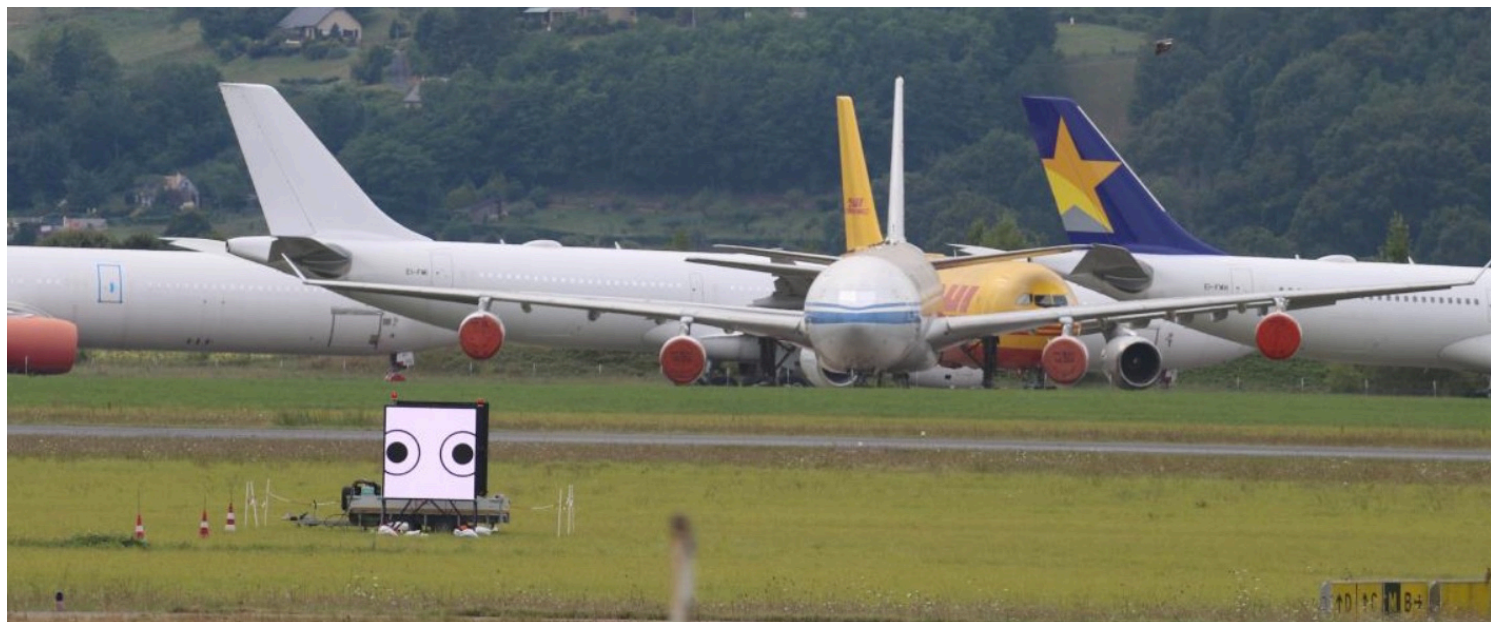
Les cercles concentriques diffusés sur les écrans digitaux éloignent durablement les rapaces. © CNRS
