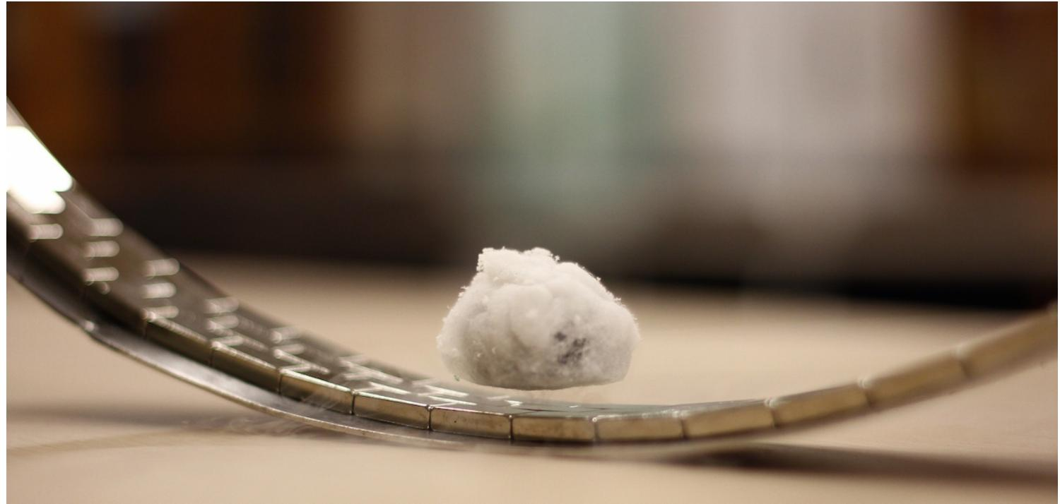
Une pastille enrubannée de coton et suffisamment refroidie devient supraconductrice et se met à flotter au-dessus des aimants qui forment les rails (c) Laetitia Theunis
