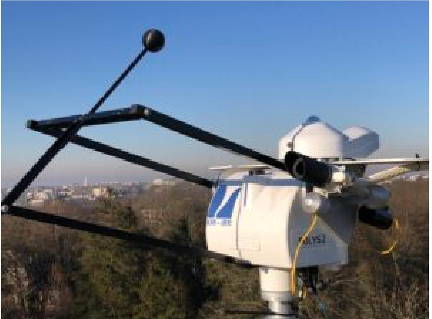
Sur le tracker, la boule noire masque le rayonnement solaire direct pour le pyranomètre, situé au sommet de l'instrument © Christian Du Brulle
