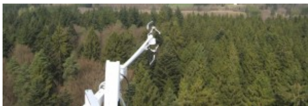
Capteurs de la tour à flux de Vielsalm. (Cliquer pour agrandir)
