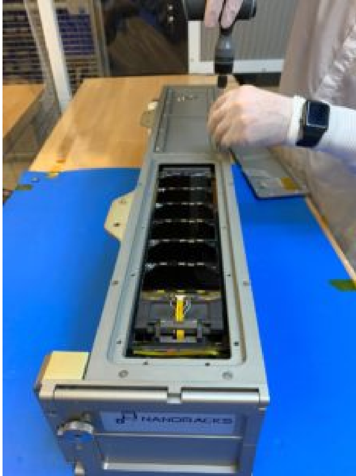
Qarman dans son système d'éjection Nanoracks © VKI
