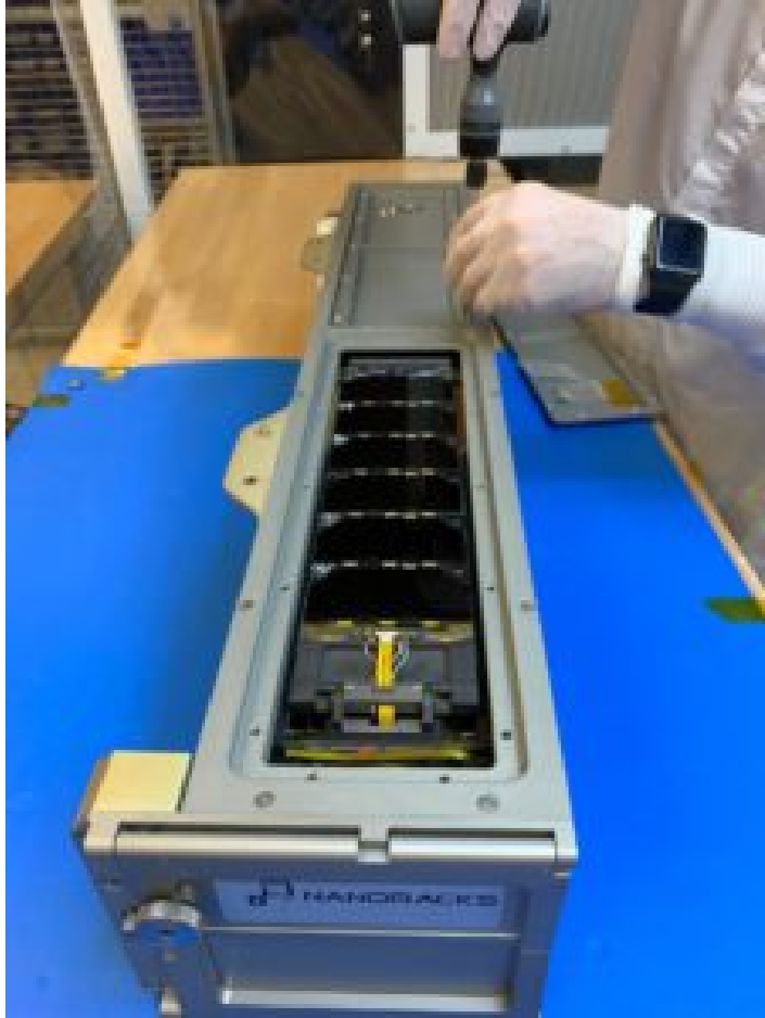
Qarman dans son système d'éjection Nanoracks © VKI
