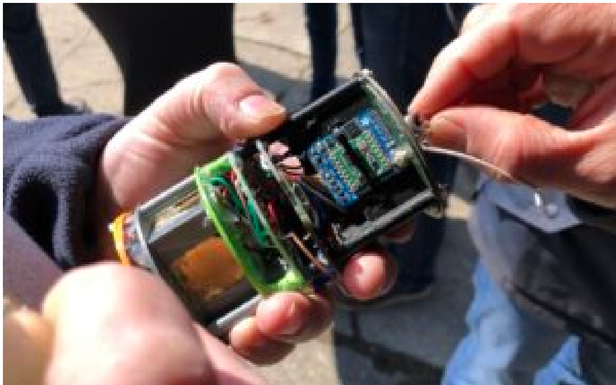
Un Cansat, soit un satellite de la taille d'une canette © Christian Du Brulle
