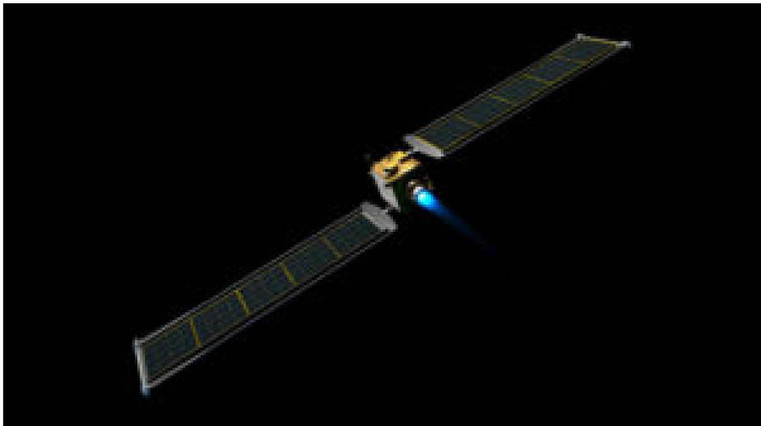
Illustration du vaisseau spatial DART avec les panneaux solaires Roll Out (ROSA) étendus. Chacun des deux réseaux ROSA mesure 8,6 mètres sur 2,3 mètres © NASA/Johns Hopkins Applied Physics Lab
