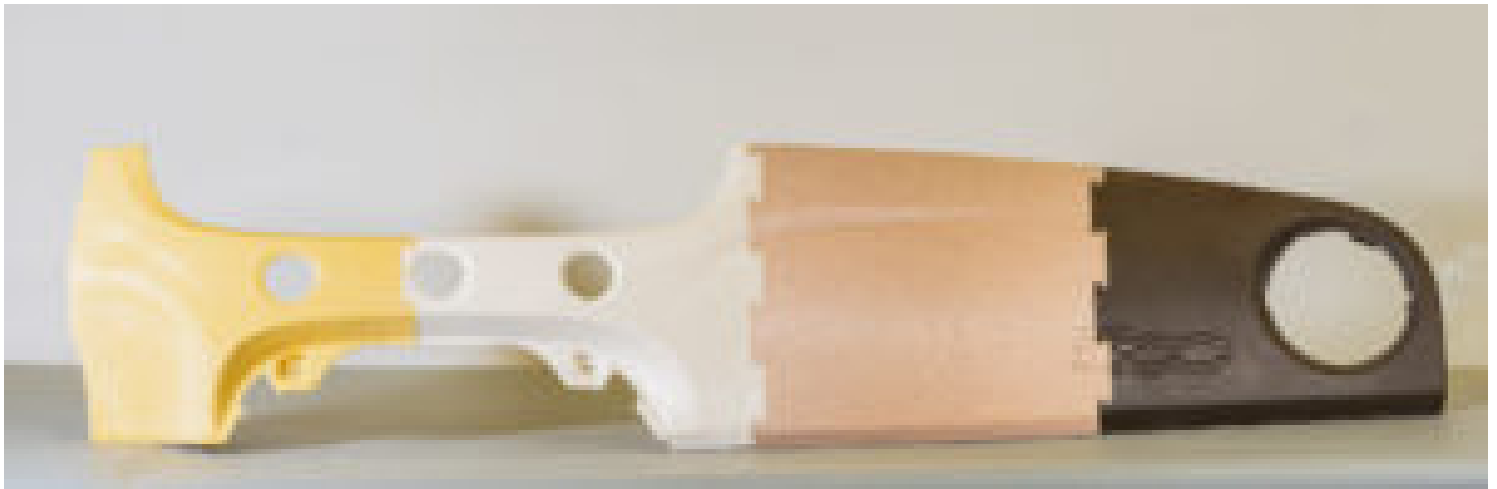
Prototype de tableau de bord (pour modèle Fiat) incorporant des pigments et des parfums de citron, des coques d'amande et des pigments de grenade © Barbara
