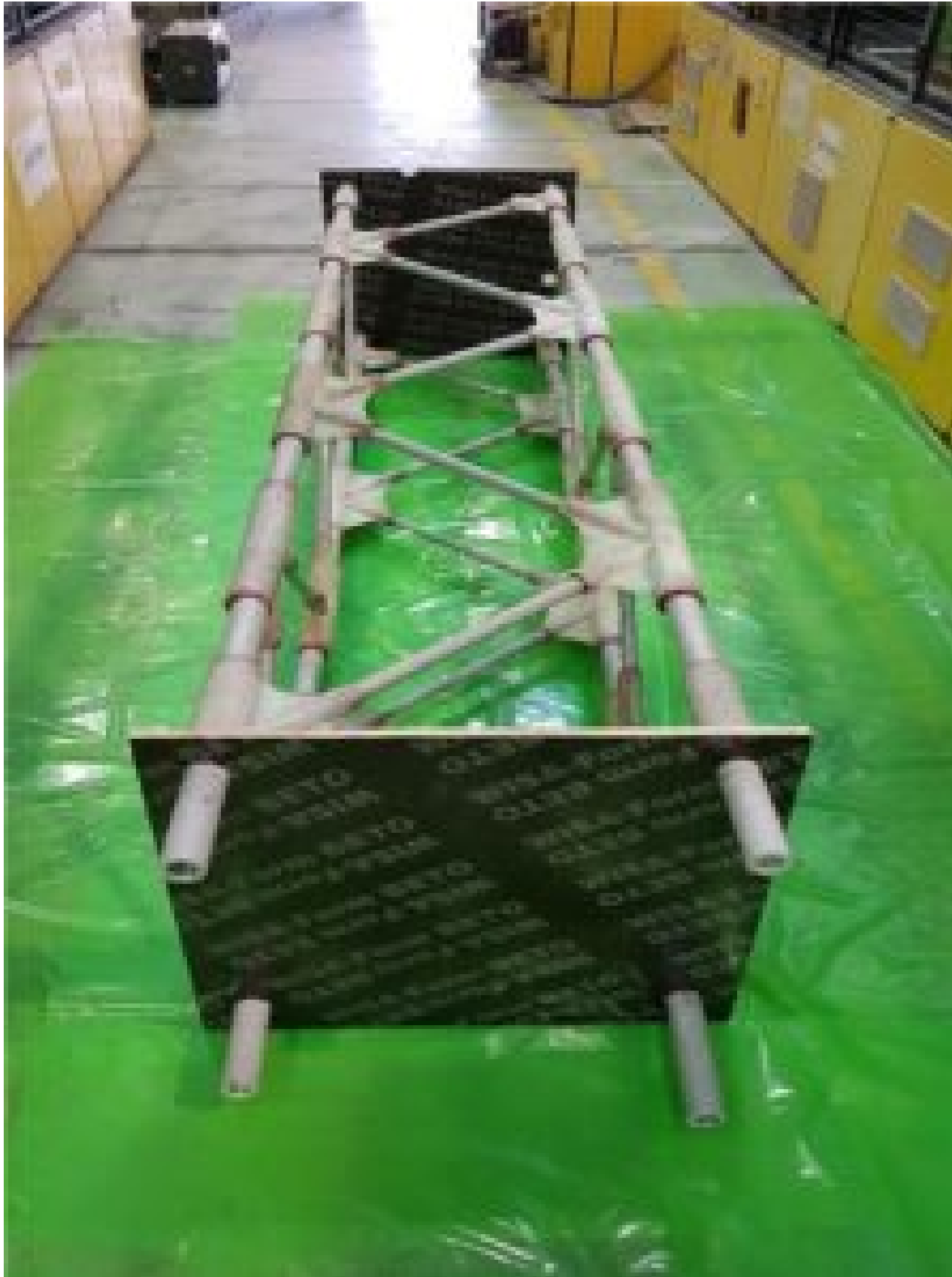
Prototype de charpente avec des joints fabriqués par impression 3-D (moulage par transfert de résine) © Barbara
