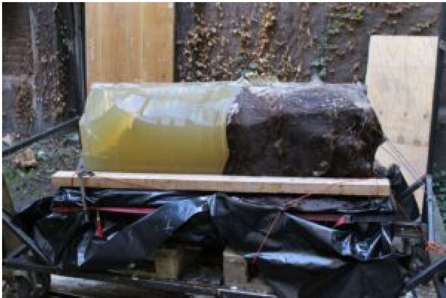
Cible en gélatine produite pour l'expérimentation © ULiège / TraceoLab
