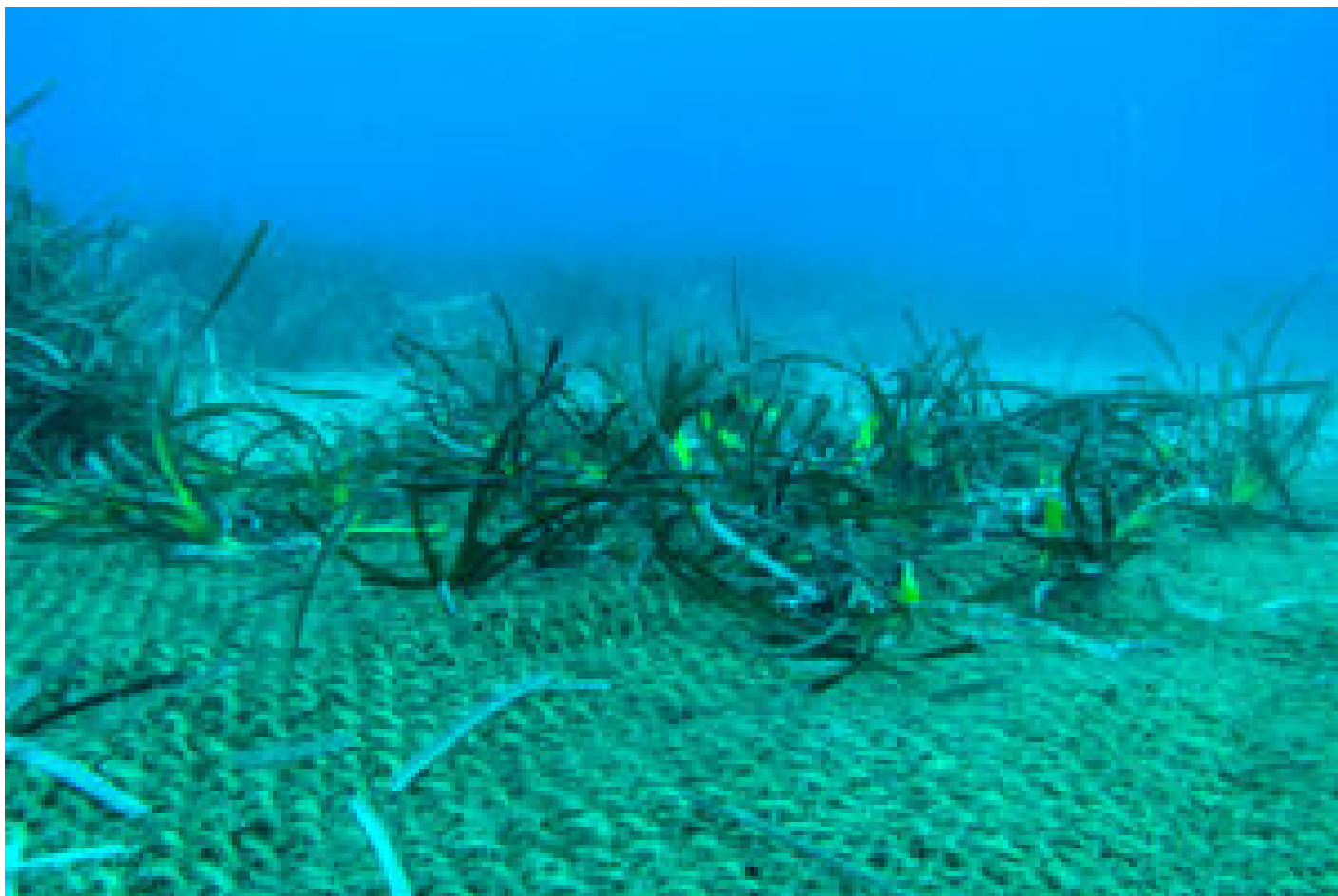
Tapis de fibre de noix de coco testé dans le cadre de la thèse d'Arnaud Boulenger © Arnaud Boulenger
