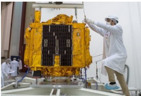
Intégration du satellite scientifique français "Microscope". © CNES - Emmanuel GRIMAUULT
