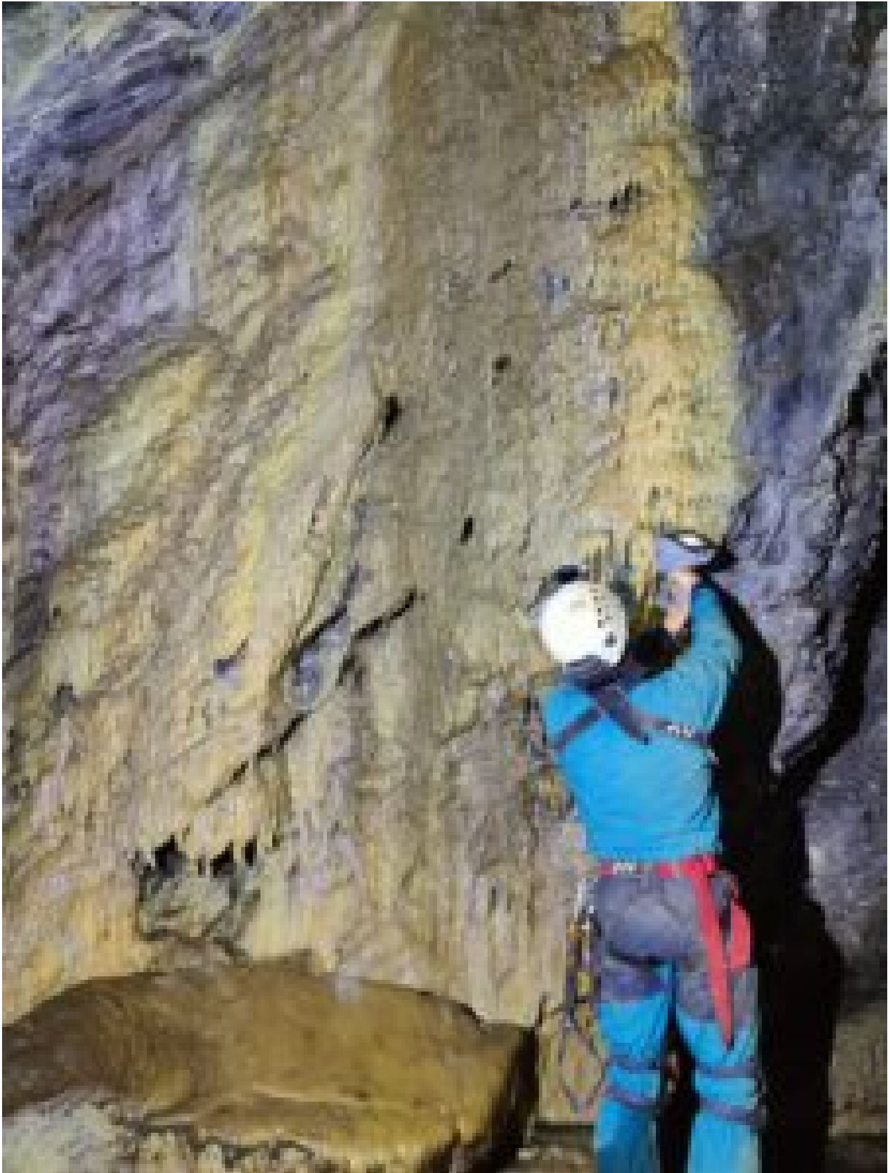
Au moyen du spectromètre portable à fluorescence X, Martin Vlieghe analyse la composition chimique d'une coulée jaune dans la Grotte de la Cigalère, à hauteur de l'affluent Gino © Stéphane Pire
