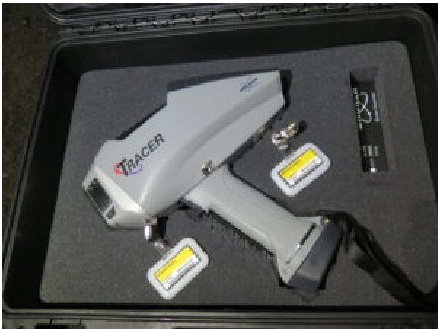
Le Spectromètre pXRF ressemble à un pistolet laser © Gaëtan Rochez
