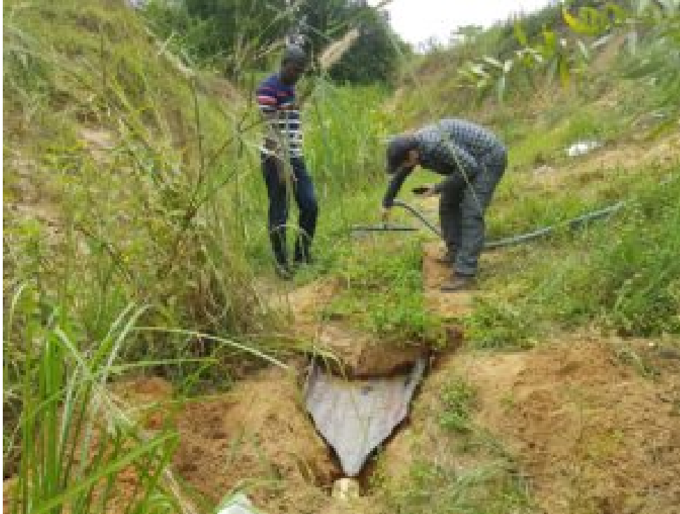
Test d'infiltrométrie © Romain Millecamps
