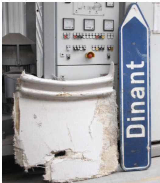
Fragments de coque de bateau et plaque de signalisation. Ces deux objets sont faits dans le même matériau composite thermodurcissable. © Laetitia Theunis
