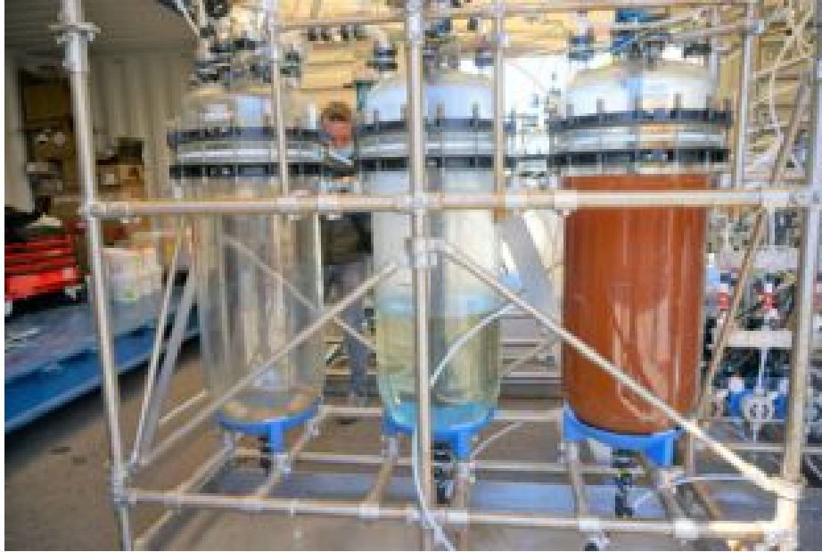
PULSE, l'unité pilote de récupération du phosphore dans les boues de station d'épuration © Laetitia Theunis
