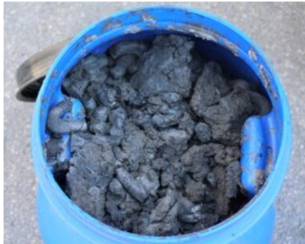
Boues de station d'épuration avant le processus de récupération du phosphore. Elles seront tout d'abord séchées en étuve puis broyées © Laetitia Theunis
