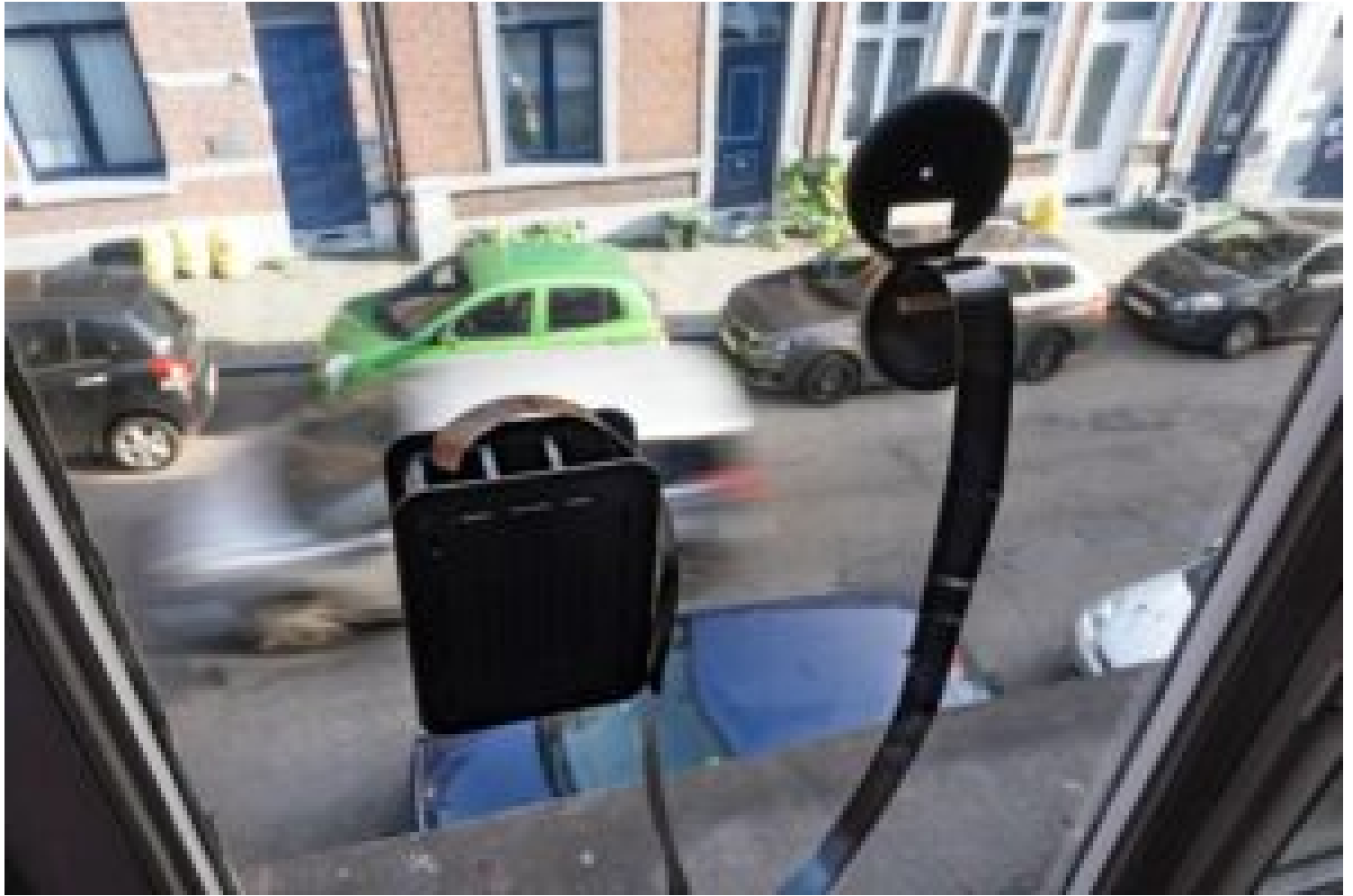
Dispositif de comptage du trafic © ISSeP
