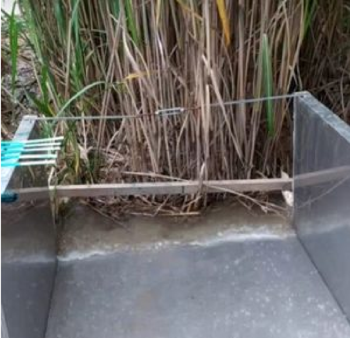
Simulateur de ruissellement dans les parcelles étudiant les barrières végétales © Uliège GxABT
